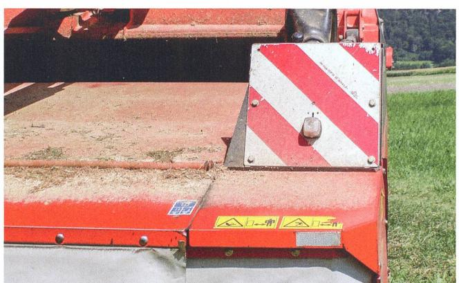
Dans la direction de transport, depuis l'avant, des panneaux de marquage rouge/blanc montrent la largeur de la machine trainée et la rendent ainsi mieux visible pour les autres usagers de la route. De nuit et par mauvaise visibilité, les feux de position attirent l'attention de la circulation en sens inverse.
