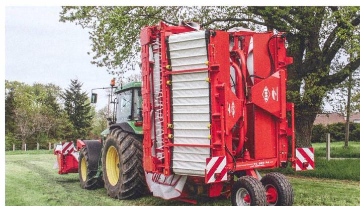
Observés depuis l'arrière, les deux lamiers disposent de panneaux de marquage aux dimensions généreuses rouge/blanc qui indiquent clairement la largeur de la machine à l'usager de la route qui suit. L'installation d'éclairage prescrite garantit la visibilité également dans l'obscurité et lors de mauvaises conditions de visibilité.
