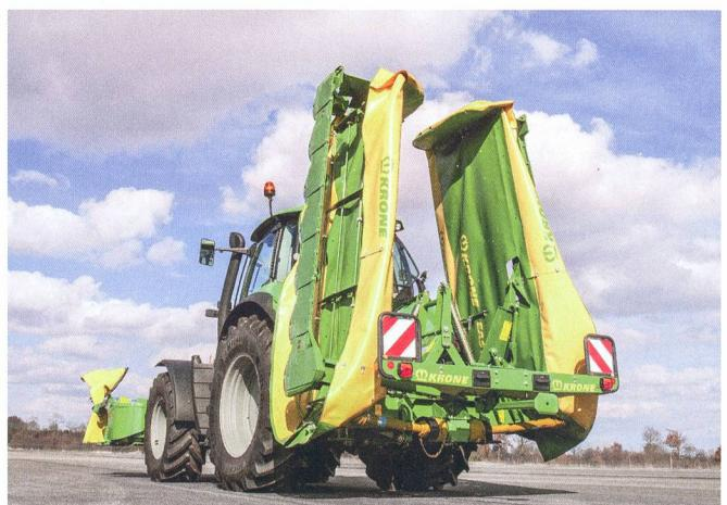
Les feux arrière du tracteur sont toujours cachés par les faucheuses transportées horizontalement. Pour cette raison, il est important que l'arrière de la machine soit signalé et dispose d'une installation d'éclairage complète.
