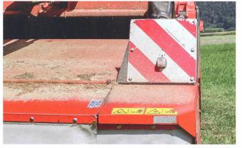
Dans la direction de transport, depuis l'avant, des panneaux de marquage rouge / blanc montrent la largeur de la machine traînée et la rendent ainsi mieux visible pour les autres usagers de la route. De nuit et par mauvaise visibilité, les feux de position attirent l'attention de la circulation en sens inverse.
