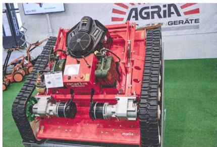
nu, la machine se pilote directement, avec grande précision. La transmission hybride innovante est alimentée par un moteur à combustion d'à peine 20 kW. Cette faucheuse destinée au broyage traite des surfaces de 1,12 m de large et s'emploie tant en marche avant qu'en marche arrière.
