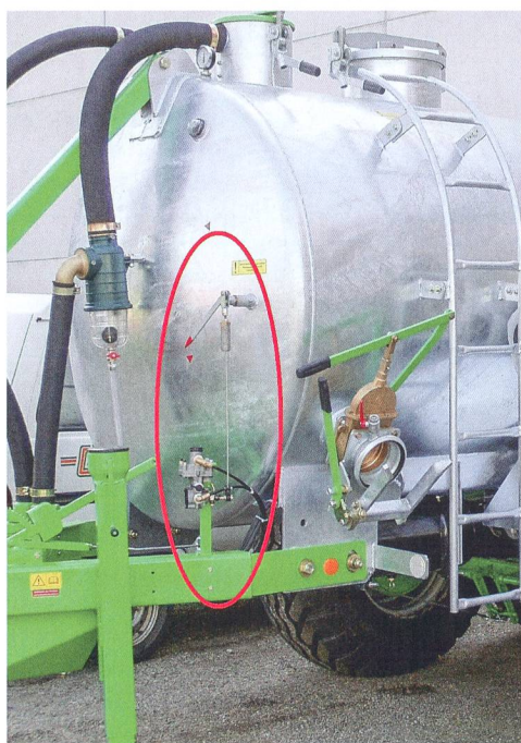
Le régulateur de force de freinage automatique dépendant de la charge (ALB) dose le freinage en fonction de la charge du véhicule. La force de freinage est réglée en fonction d'un indicateur de niveau et de la tension du câble. Photo: Hunger
