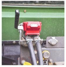
Grâce aux accouplements rapides Duo-Matic, les freins pneumatiques s'accouplent plus rapidement et plus facilement qu'avec des têtes d'accouplement. Photo: Hunger
