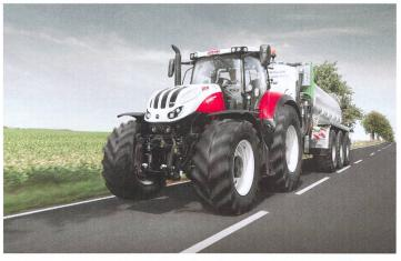
Combiné au système électronique de freinage (EBS), la régulation de la force de couplage permet d'adapter le freinage de la remorque à celle du véhicule de manière optimale. Photo: Steyr
