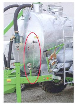
Le régulateur de force de freinage automatique dépendant de la charge (ALB) dose le freinage en fonction de la charge du véhicule. La force de freinage est réglée en fonction d'un indicateur de niveau et de la tension du câble. Photo: Hunger
