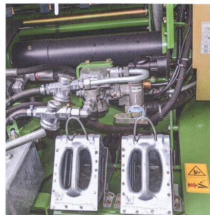
Les freins pneumatiques (ici sur une presse à balles rondes) ont fait leurs preuves depuis des décennies sur les véhicules de transport. Les agriculteurs les utilisent volontiers. Photo: Hunger
