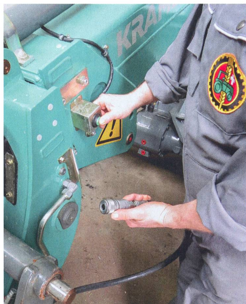
Une touche de délestage facilite le branchement-débranchement des tuyaux hydrauliques du verrouillage de l'attache vers l'outil.
