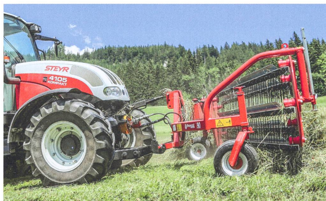
L'andaineur est guidé par deux roues de jauge...
