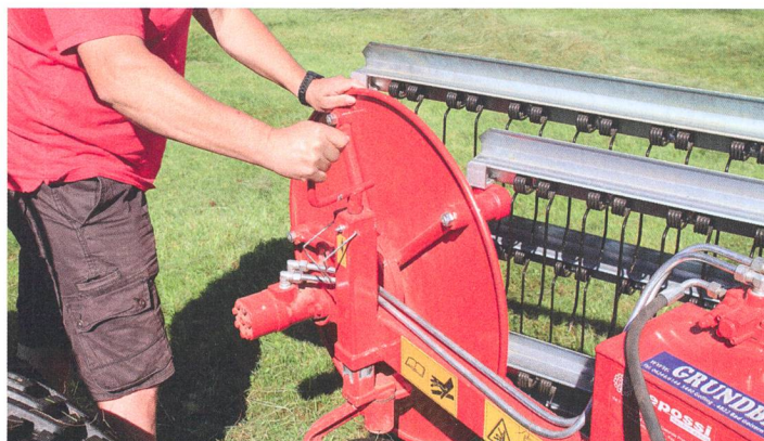
... qui se règlent en hauteur et en continu par manivelles.
