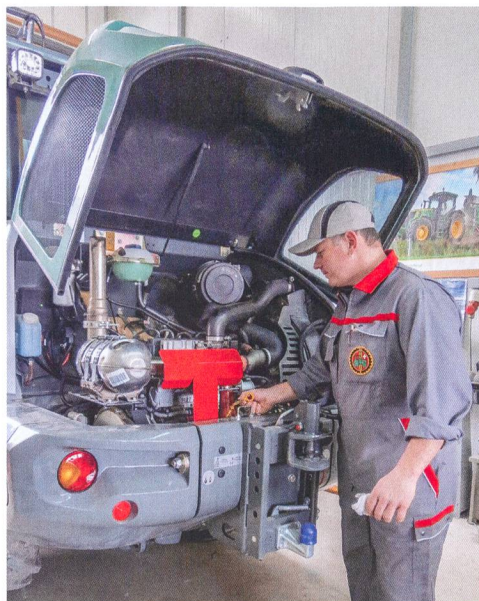
Le capot monobloc et à large ouverture permet un accès facile aux points d'entretien et aux services de maintenance.
