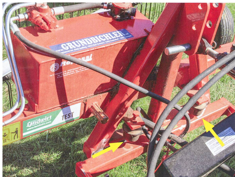
Attelage trois-points oscillant avec butées ajustables en caoutchouc.
