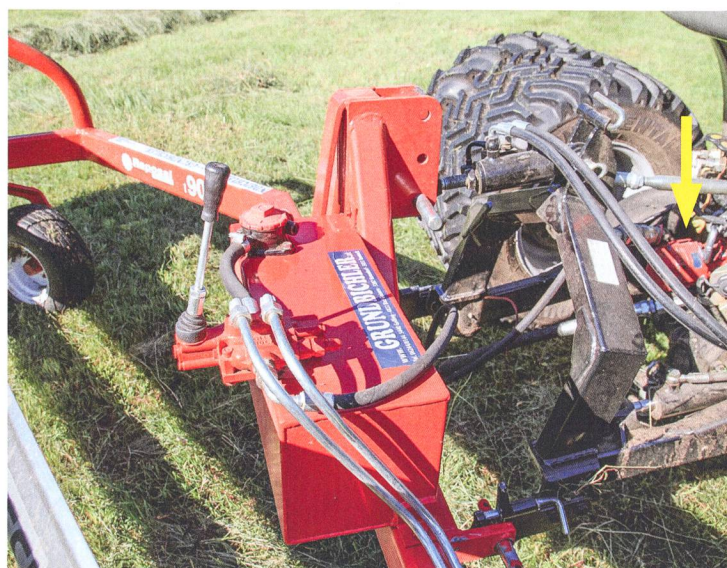
Alimentation propre en huile avec une pompe à prise de force.
