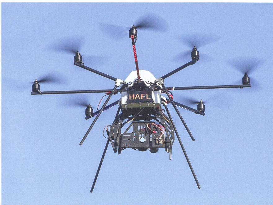
Le prototype de l'« ISA – Wildretter V2.0 » doté d'un design innovant, de nouveaux capteurs, d'un assistant de traçage et d'accus rechargeables. Introduction sur le marché en 2017.
