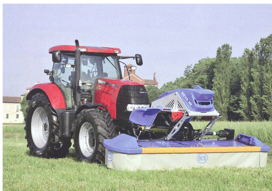
La nouvelle faucheuse « frontale BCS NEVA » est équipée d'un système de déflecteurs qui doit garder la poussière et les particules éloignées du refroidissement du tracteur pendant le fauchage.
