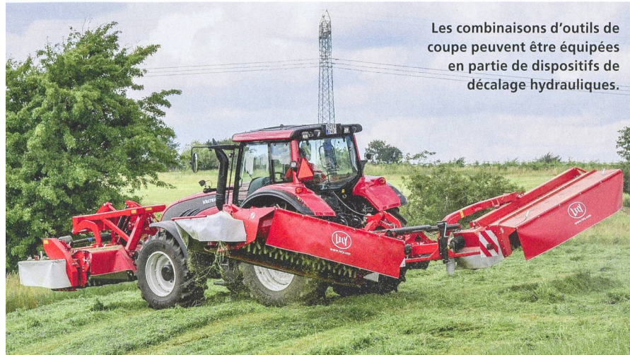
Les combinaisons d'outils de coupe frontaux et arrière permettent de couvrir des largeurs de travail allant jusqu'à 12 mètres.
