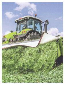
Après le réglage de base, le réglage du délestage hydraulique ou hydropneumatique des outils de coupe s'effectue à partir de la cabine.
