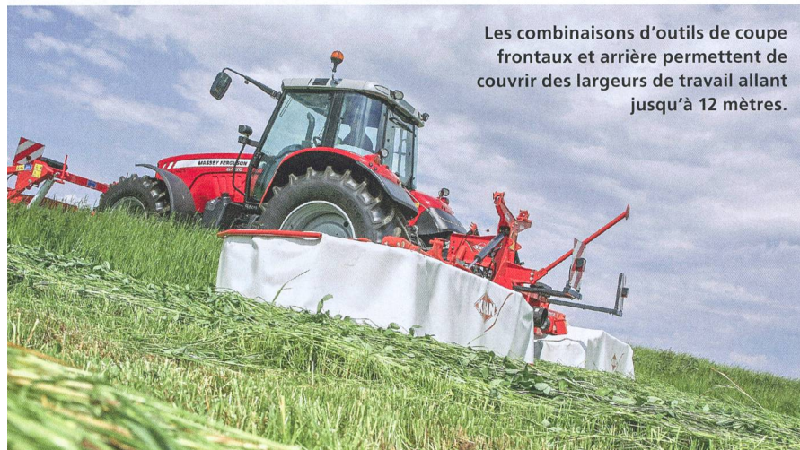
Cette combinaison frontale / latérale dépose le fourrage sur un andain avec sa vis d'alimentation intégrée.
