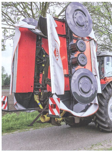
Les outils de coupe à tambours sont entraînés par le haut et sont équipés de plateaux à libre rotation. Les dimensions des tambours peuvent varier.
