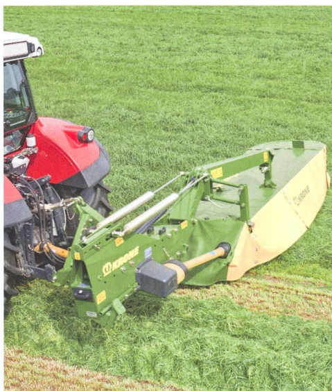
Chaque moitié de la barre de coupe est délestée par l'un des deux ressorts à spirales. L'interaction des ressorts fait que la pression d'appui reste uniforme sur toute la largeur de coupe.
