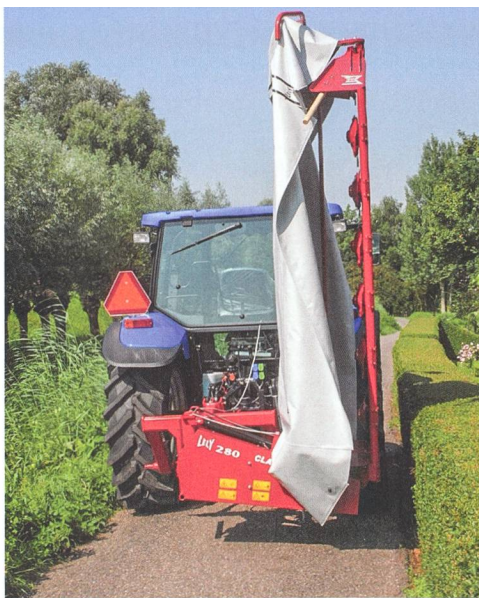
Les outils de coupe à disques ont une barre inférieure servant d'élément de support aux disques de coupe.
