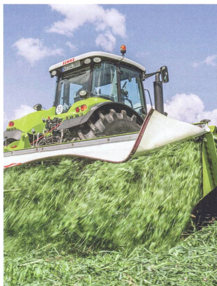
Après le réglage de base, le réglage du délestage hydraulique ou hydropneumatique des outils de coupe s'effectue à partir de la cabine.
