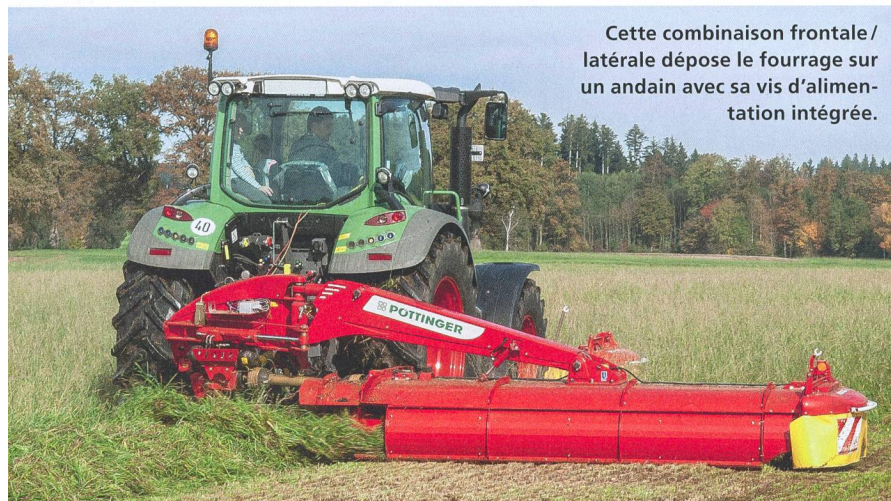
La mise en andains peut, en fonction de la production de fourrage et du traitement ultérieur, se faire sur un ou sur deux côtés.
