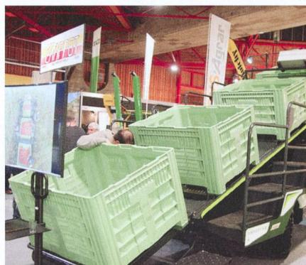
pleins, ils sont pris en charge par un élévateur qui les dépose à terre. Le processus se déroule en continu. Cet appareil peut être doté d'un système d'autoguidage. Sécurisé, il a été développé en collaboration avec des spécialistes en prévention des accidents.
