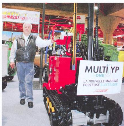
Le constructeur valaisan présentait aussi le premier prototype de son porte-outils viticole électrique, le « Multi-Jyp E-One ». Il embarque quatre batteries, dont deux alimentent les moteurs d'entraînement de la transmission. Le prochain défi consistera à développer des outils électriques adaptés à cette machine, explique Jean-Yves Chappot.
