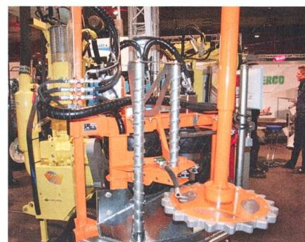
puie les bois contre une chaîne en direction d'une paire de roues tournant en sens opposé qui extrait les sarments du palissage. Montée sur un tracteur vigneron, la tireuse remplace une opération manuelle fastidieuse.
