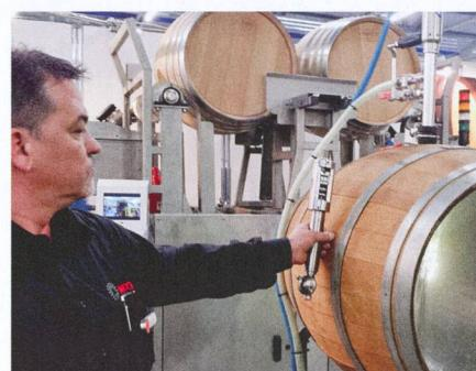
La maison Moog, de Worb (BE), s'est taillé une renommée mondiale dans le lavage des fûts et récipients de toutes sortes. Elle a exposé un appareil de rinçage de tonneaux dont la tête de lavage à rotation lente est entraînée par la pression de l'eau et qui intègre un dispositif aspirant l'eau des récipients. L'entraînement à pression d'eau permet d'atteindre un résultat équivalent comparé à un appareil à entraînement électrique, mais présente un meilleur niveau de sécurité.
