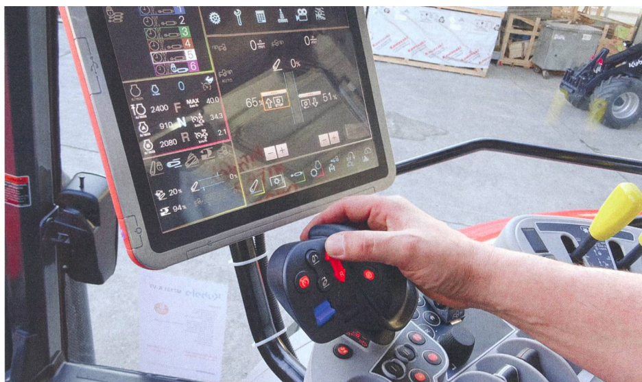
Équipement «Premium»: levier de commande multifonctions intégré à l'accoudoir (fonctions Hydraul et transmission), appareils de commande électriques et écran Isobus.
