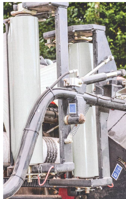
Pour le processus de liage, Kuhn fait pivoter les rouleaux de film de 90° (la photo montre l'état au repos). On peut apercevoir sous l'introduction du film, le rouleau à filet pouvant servir d'alternative en cas de liage par filet.
