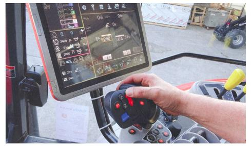
Equipement «Premium»: levier de commande multifonctions intégré à l'accoudoir (fonctions Hydrail et transmission), appareils de commande électriques et écran Isobus.
