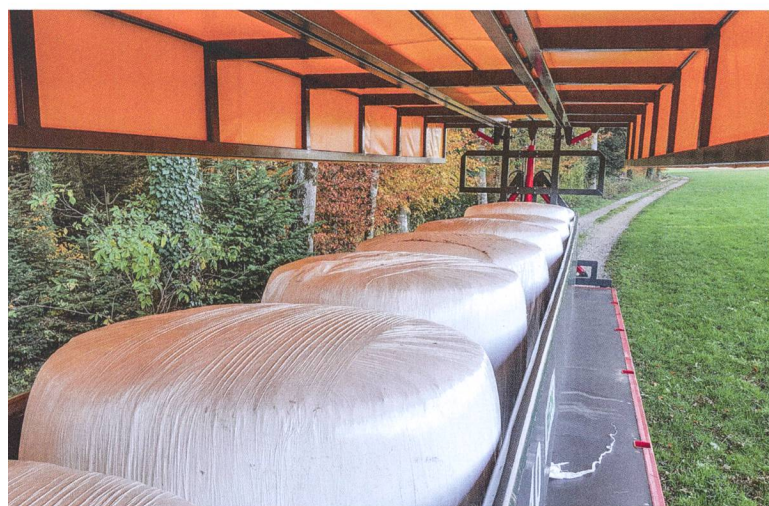
Les grilles latérales peuvent aussi serrer des chargements jusqu'à un écart de 1 mètre à l'intérieur de la surface de chargement.
