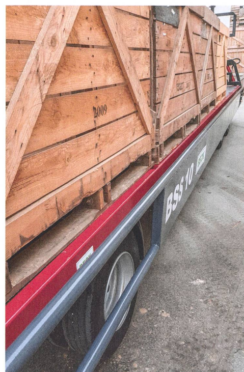
Lors du chargement et du déchargement, les grilles latérales se trouvent sous la surface de chargement, cela permet à un chariot-élévateur de charger sans obstacle.
