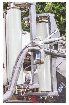
Pour le processus de liage, Kuhn fait pivoter les rouleaux de film de 90° (la photo montre l'état au repos). On peut apercevoir sous l'introduction du film, le rouleau à filet pouvant servir d'alternative en cas de liage par filet.
