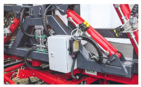
Chaque vérin hydraulique est équipé d'une vanne à commande électrique. Situé à l'avant de la remorque, le coffret de commande est équipé d'un clavier à membrane pour une commande d'urgence.
