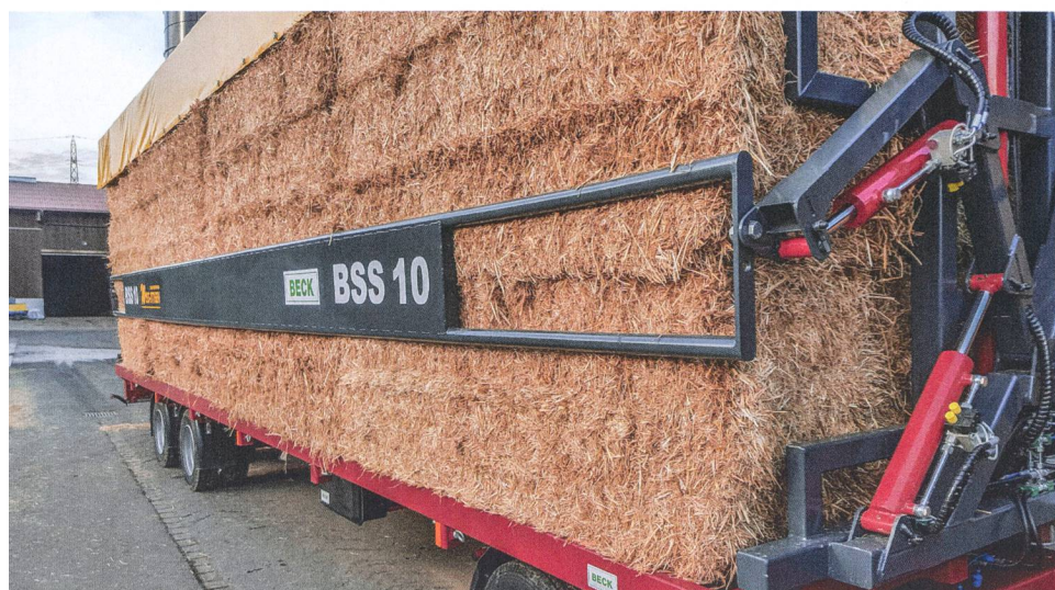
Grâce aux articulations doubles, la hauteur des grilles latérales peut être adaptée aux différentes dimensions de balles. Photos Ruedi Burkhalter, Joël Mosimann
