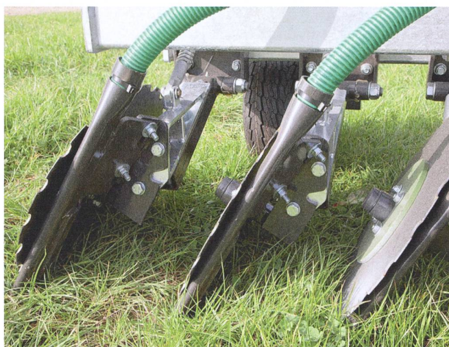
En fonction de son réglage angulaire, l'enfouisseur à disques Fliegl peut aussi couper le sol latéralement. Les disques ont un diamètre de 530 mm. Photo : Fliegl
