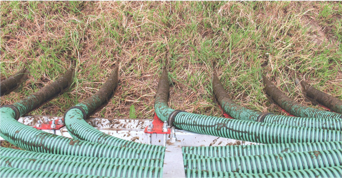
L'épandeur à patins se faufile dans l'herbe en évitant ainsi de la souiller. Il dépose le lisier au sol et réduit ainsi fortement les émissions.
