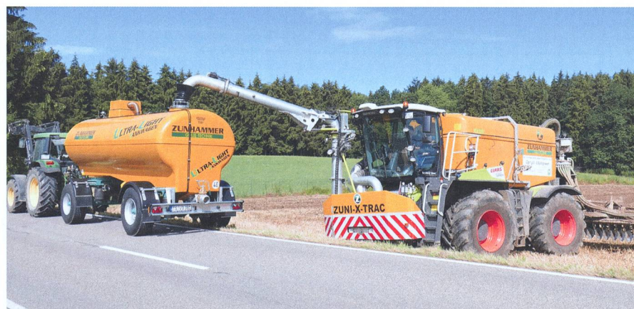
Une nouvelle conception des citernes de transport a permis une réduction du poids pour un volume inchangé, voire supérieur. Photo : Zunhammer
