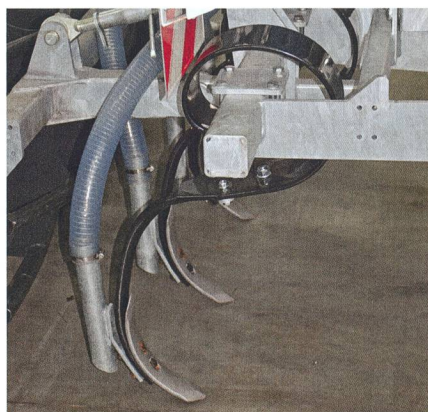
Enfouisseur à dents Vibroflex, à une poutrelle. Le lisier est introduit dans le sol immédiatement derrière les dents.
