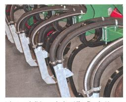
Injecteur de lisier sur la dent Vibroflex de 40 × 40 mm du cultivateur-enfouisseur Lomma. Le lisier est amené par deux tuyaux (trois au niveau des dents extérieures).
