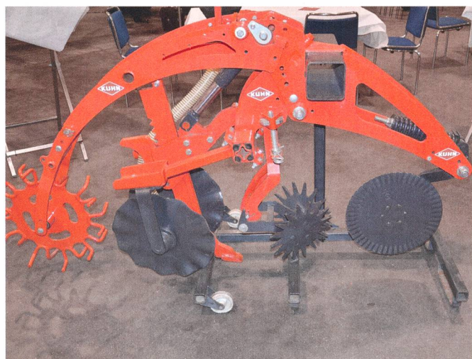
Le principe « Striger » de Kuhn pour le procédé « strip-till ».
