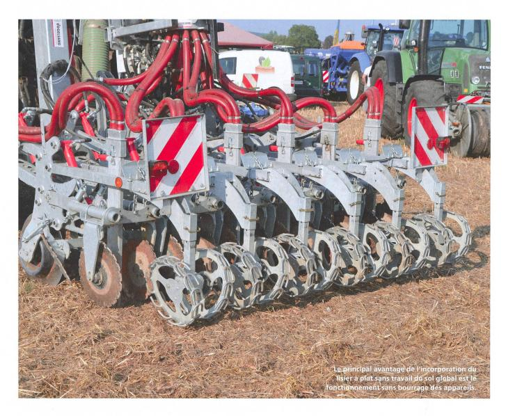
extérieurs. La deuxième variante offre en plus la possibilité de fermer les tronçons du milieu à l'aide de soufflets pneumatiques sur la tête de distribution, mais en laissant les disques au sol. Le niveau d'équipement le plus élevé combine les deux procédés. Pour assurer un écoulement régulier du lisier dans les tronçons restés ouverts, Vredo agit aussi sur la vitesse de rotation de la pompe.
