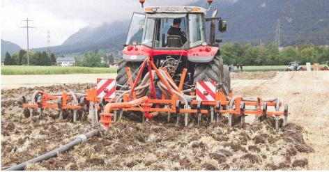
Les cultivateurs-enfouisseurs portés, alimentés en lisier par des tuyaux extérieurs, offrent une véritable alternative à la plupart des machines de la technique du lisier, dont le poids est souvent
