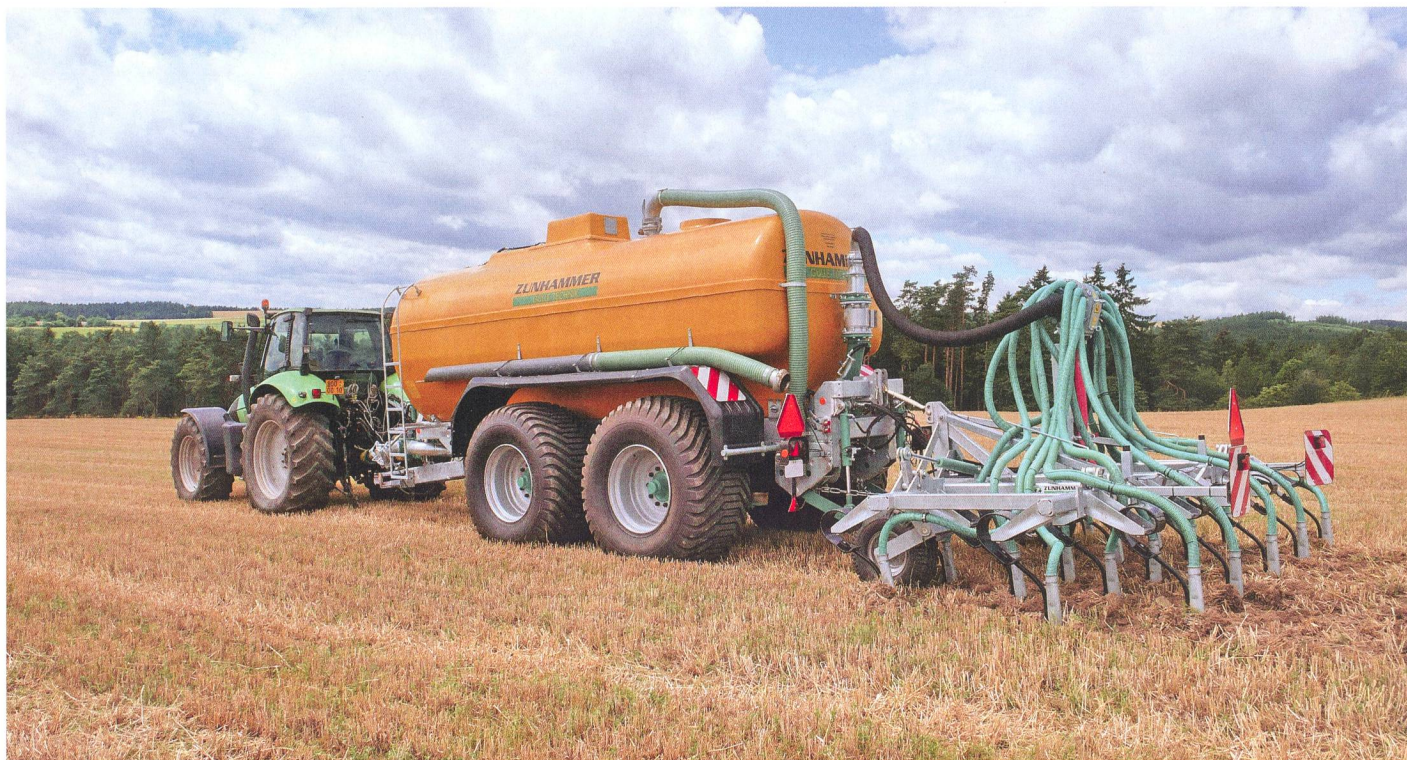
Le cultivateur-enfouisseur entaille le sol avec ses dents. L'effort de traction dépend du nombre de dents d'une part, et des caractéristiques du sol d'autre part.
