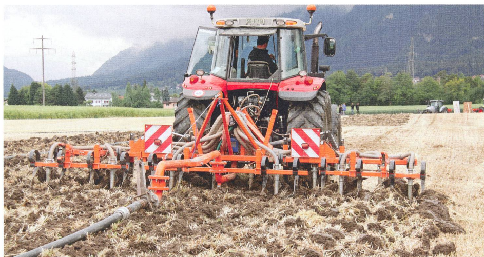
Les cultivateurs-enfouisseurs portés, alimentés en lisier par des tuyaux extérieurs, offrent une véritable alternative à la plupart des machines de la technique du lisier, dont le poids est souvent excessif.
