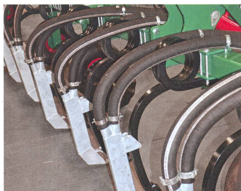
Injecteur de lisier sur la dent Vibroflex de 40 x 40 mm du cultivateur-enfouisseur Lomma. Le lisier est amené par deux tuyaux (trois au niveau des dents extérieures).
