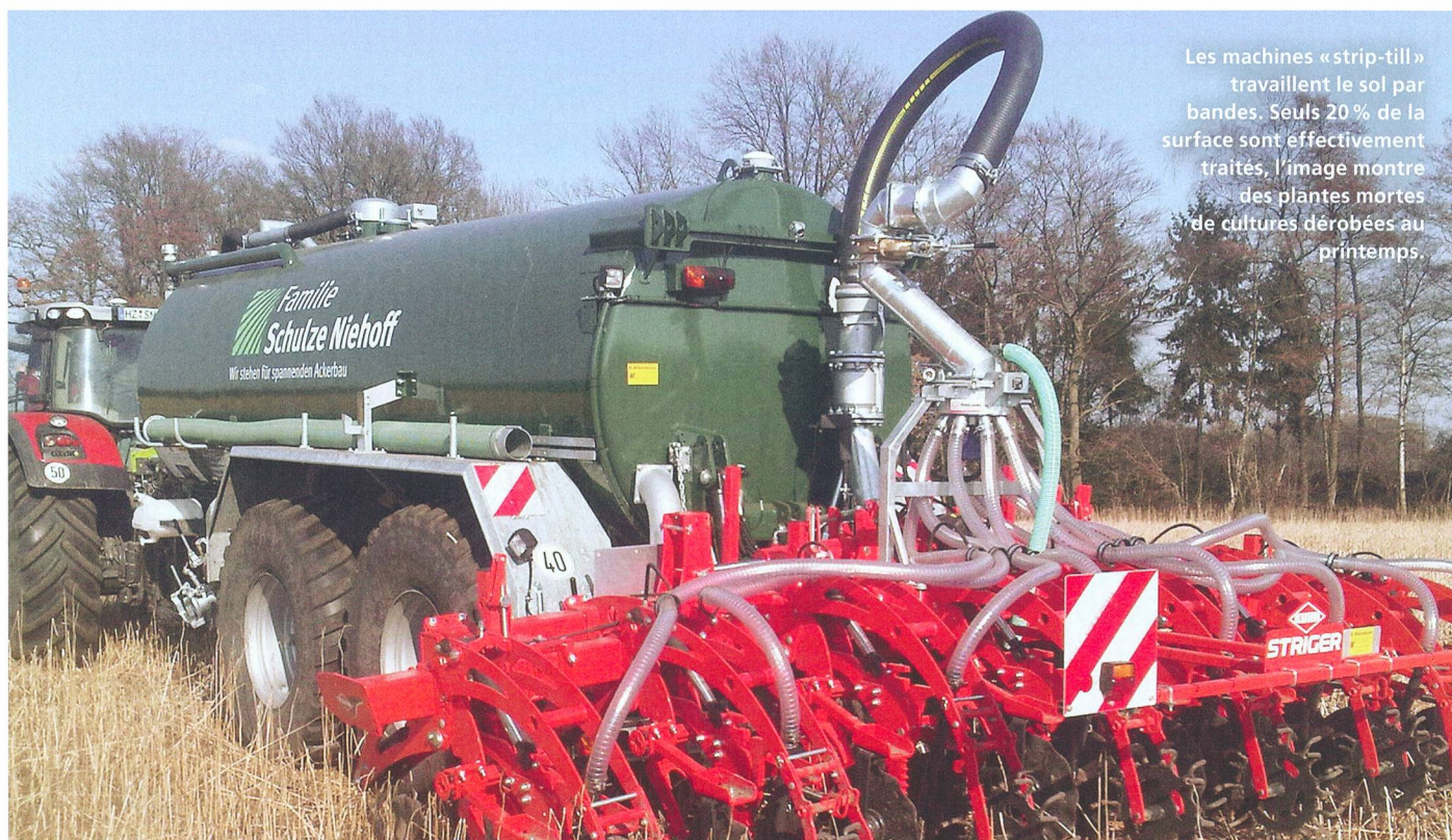
Le principe « Striger » de Kuhn pour le procédé « strip-till ».
