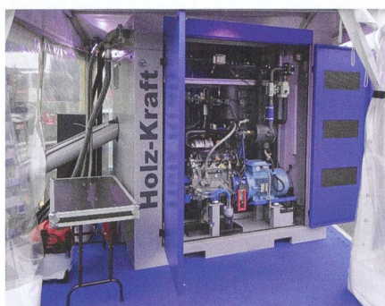
Chaudière Spanner avec gazéificateur de bois, 9 kW de puissance électrique et 25 kW de puissance thermique.
