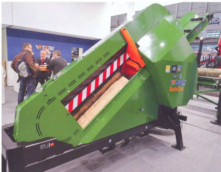
Posch AutoCut scie avec contrôle numérique du tronçonnage dont le prix s'élève à 21 000 €. Photos: Carsten Brüggemann
