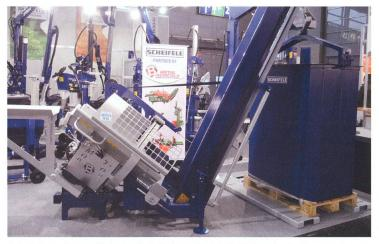
Scie à chevalet oscillant incliné de la société Scheifele, placée devant un enrouleur à tambour de forme rectangulaire permettant une utilisation optimale des Europalettes.
