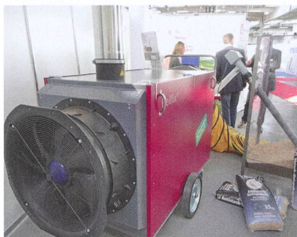
La société Energynova à Diessenhofen (TG) a présenté un générateur mobile d'air chaud, dont la chaudière est proposée en trois tailles, entre 120 et 230 kW.
