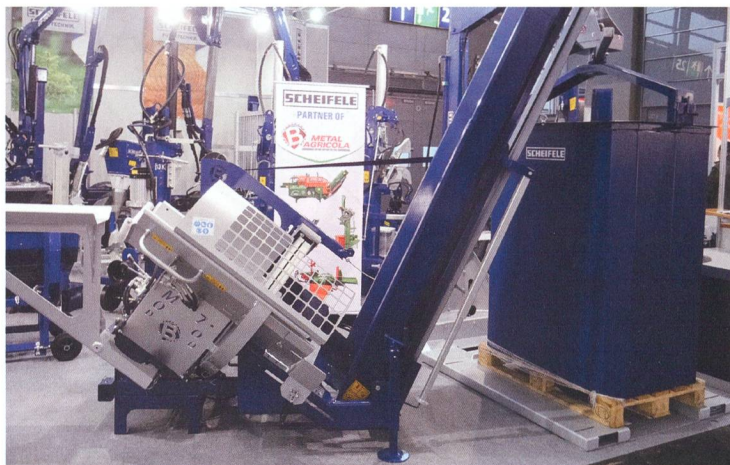
Scie à chevalier oscillant inclinée de la société Scheifele, placée devant un enrouleur à tambour de forme rectangulaire permettant une utilisation optimale des Europallettes.
