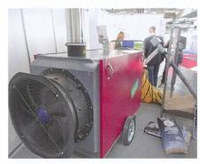
La société Energynova à Diessenhofen (TG) a présenté un générateur mobile d'air chaud, dont la chaudière est proposée en trois tailles, entre 120 et 230 kW.
