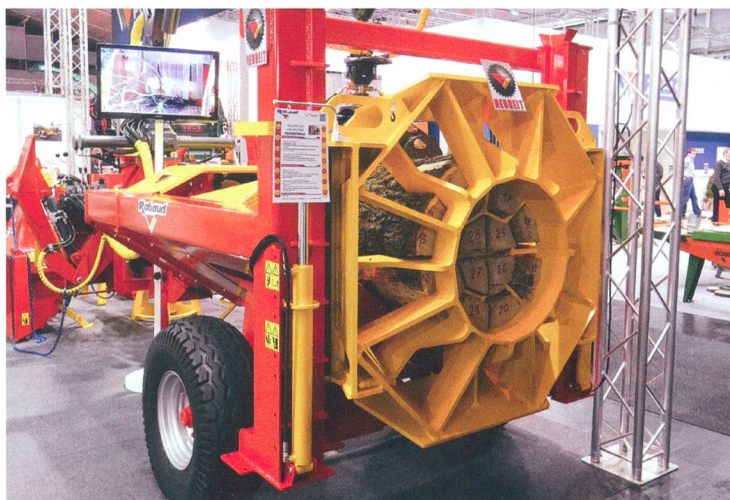
La fendeuse de bûches horizontale «F80» de Rabaud développe un effort de fendage de 80 t et peut produire jusqu'à 28 éclats à chaque course.
