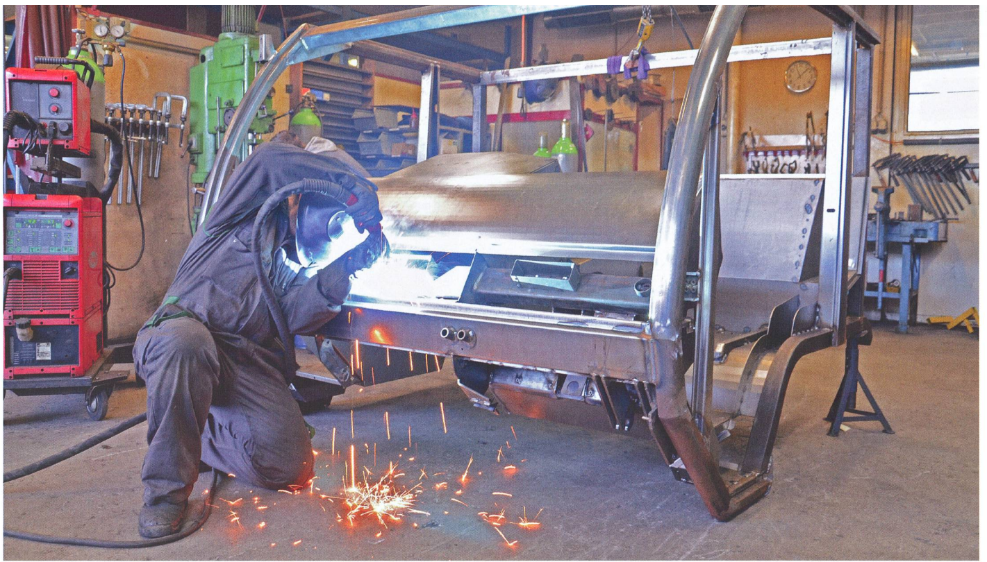
Naissance d'un Schiltrac: la cabine à la forme caractéristique est dessinée et construite en interne suivant les directives de l'OCDE.
