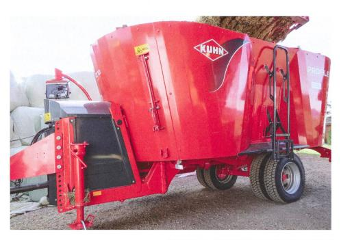
Modèle Kuhn «Profile 1270»: bonne fabrication robuste avec une capacité de 12 m³ et de nombreuses options idéales pour les conditions suisses.
