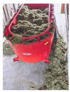
Une éjection uniforme de fourrage est effectuée par les deux racloirs supplémentaires fixés sur la vis.
