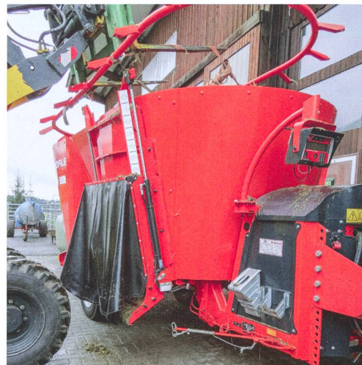
La couronne antidébordement démontée réduit la hauteur de la machine de 13 cm. Il faut la laisser quand on travaille avec une grande part de fourrage sec.
