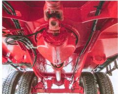
Le châssis rigide est soudé à la caisse sur toute sa longueur. Le train d'engrenage massif et la transmission y trouvent leur place.
