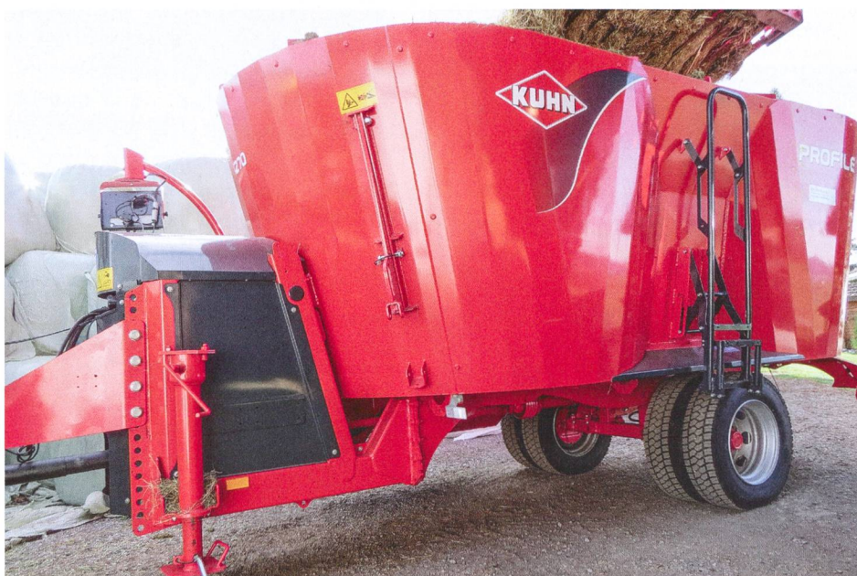
Modèle Kuhn «Profile 1270»: bonne fabrication robuste avec une capacité de 12 m 3 et de nombreuses options idéales pour les conditions suisses.
