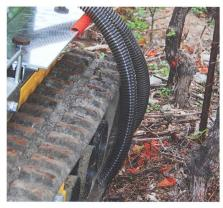
Les tuyaux partant latéralement du distributeur amènent l'engrais au pied des ceps avec précision.
