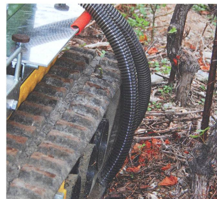
Les tuyaux partant latéralement du distributeur amènent l'engrais au pied des ceps avec précision.
