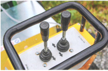
Les manettes de commande du chenillard permettent d'agir directement sur les deux chenilles.
