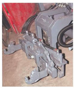
Le relevage d'un Vitiplus, avec vérin de déport, est spécialement conçu pour le guidage d'outils viticoles.
