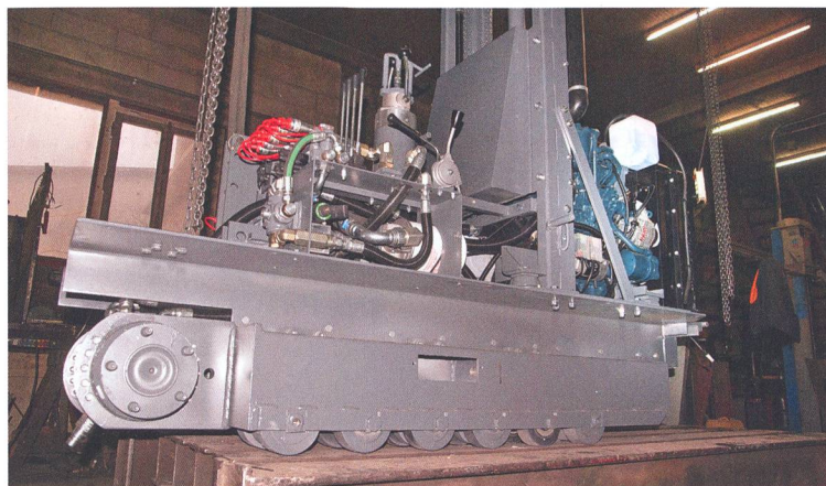
Les constructeurs de porte-outils mettent notamment l'accent sur la rigidité et la robustesse des trains de chenilles, qui sont un des points faibles des machines de transport de série proposées sur le marché.
