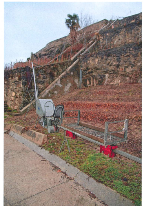
Ce type de monorail permet de mécaniser les transports dans les terrasses. Ici une installation au-dessus de Rivaz (VD). Ils sont nombreux aussi en Valais. Leur renouvellement est aujourd'hui problématique.
