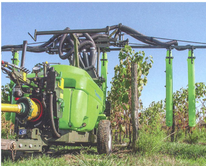
Le pulvérisateur tracté « Technoma » est équipé d'un ventilateur radial et de dispositifs de traitement suspendus perpendiculairement.
