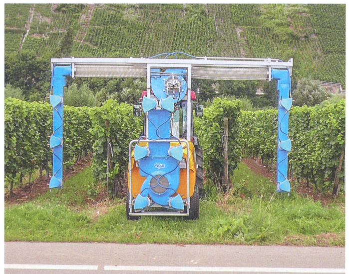
Les rampes de buses du pulvérisateur « Sexauer-Vicar » se règlent en fonction de la hauteur des plantes et du feuillage.
