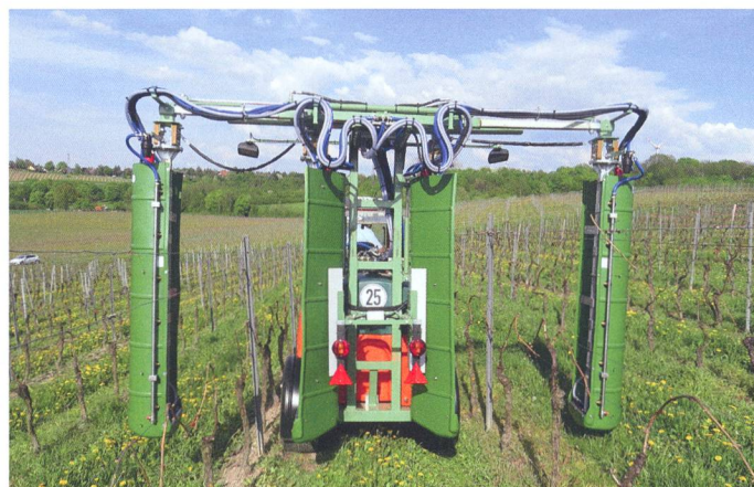
Les souffleuses tangentielles ont une technique de ventilation particulière. Leur profil de flux d'air presque horizontal et très régulier s'avère très convaincant. Photo d'usine
