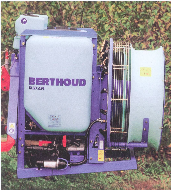
Les souffleuses axiales s'utilisent facilement comme outil porté sur tracteur.
