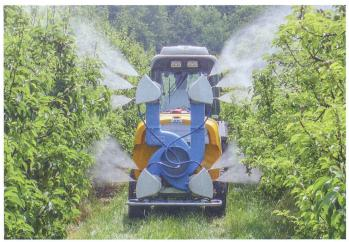
Pulvérisateur Sexauer/Vicar avec souffleuse radiale et buses à jet en éventail. Photo d'usine
