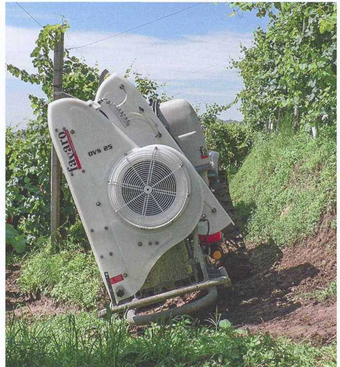
Souffleuse radiale double à flux transversal, utilisable également dans des conditions difficiles.
