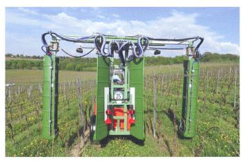
Les souffleuses tangentielles ont une technique de ventilation particulière. Leur profil de flux d'air presque horizontal et très régulier s'avère très convaincant. Photo d'usine
