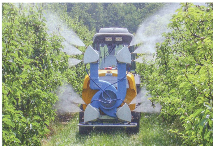
Pulvérisateur Sexauer / Vicar avec souffleuse radiale et buses à jet en éventail. Photo d'usine
