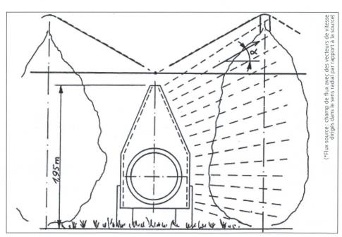
Schéma. Le flux supérieur incliné assure le meilleur angle d'attaque possible pour le sommet de l'arbre. Cependant, une mauvaise utilisation accroît le risque de dérive vers le haut.
