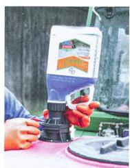
Les systèmes de remplissage et d'extraction fermés évitent les éclaboussures et protègent l'homme et l'environnement.
