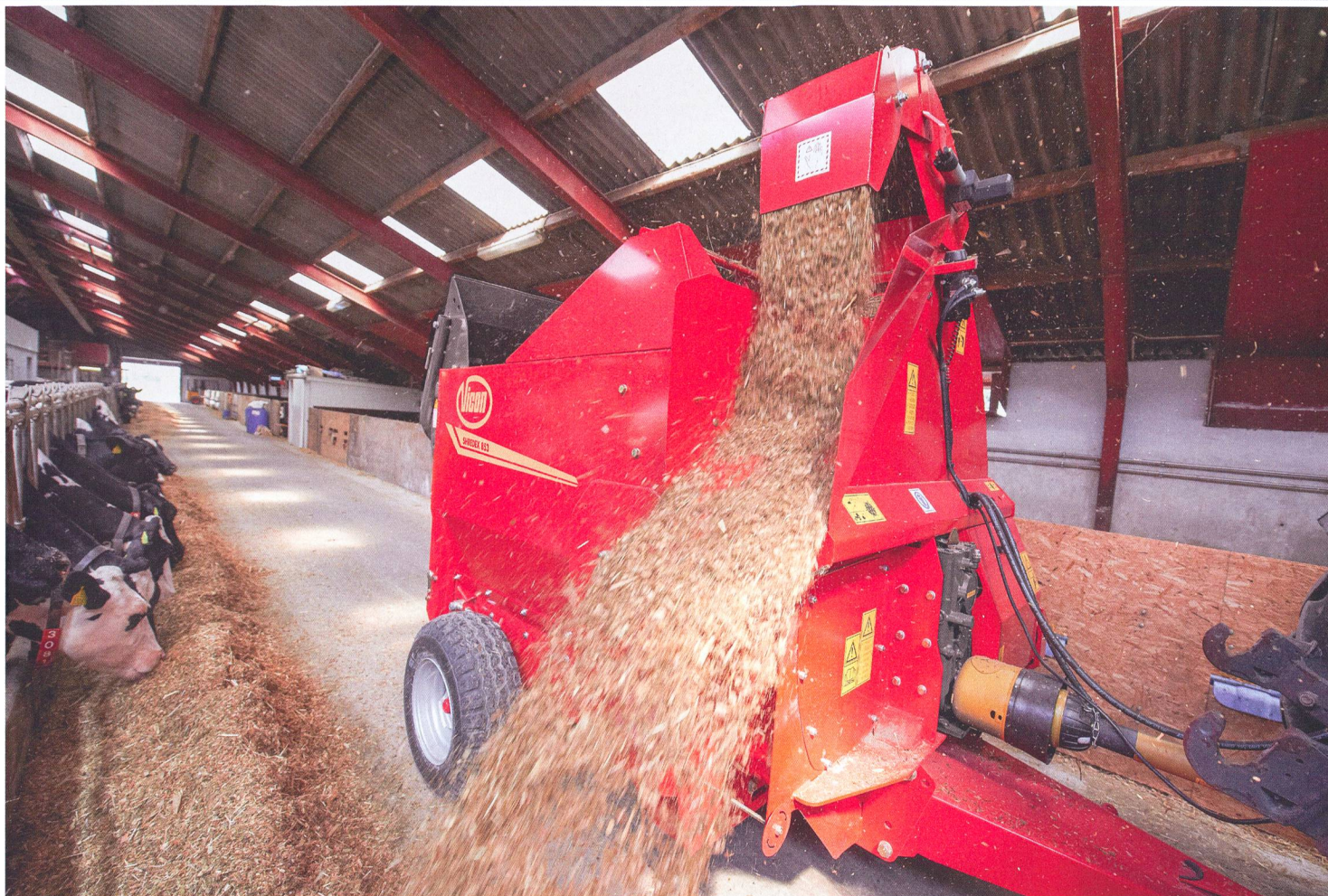
Avec le Vicon « Shredex », foin et ensilage sont déposés directement dans l'auge via un plateau de distribution.
