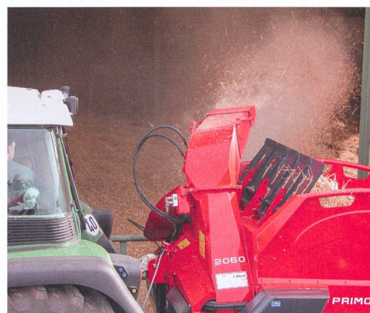
Le Kuhn « Primor » est un spécimen typique de machine combinée, permettant aussi bien de distribuer du fourrage que d'effectuer le paillage.
