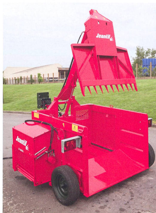
Il existe des engins intégrant un outil de chargement avec ou sans bras télescopique. La griffe de reprise est mue hydrauliquement.
