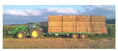
Des rallonges escamotables permettent d'adapter la longueur de la remorque à celle du chargement et d'optimiser les capacités de transport. Photos: Beck, Burgdorf
