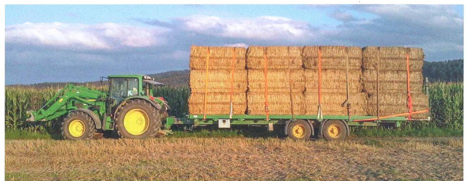
Des rallonges escamotables permettent d'adapter la longueur de la remorque à celle du chargement et d'optimiser les capacités de transport. Photos: Beck, Burgdorf
