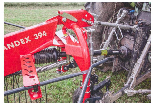
L'attelage se bloque automatiquement dès que la machine est soulevée, empêchant ainsi tout pivotement en direction de la vallée.
