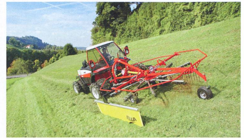
Le support d'attelage fixe permet d'utiliser les giro-andaineurs légers en attelage frontal.
