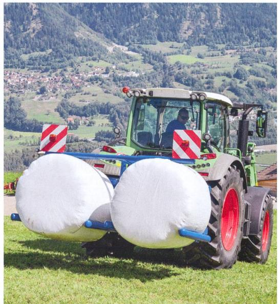
Tant la sécurisation du chargement que le dispositif d'éclairage sont ici corrects. Toutefois, ce véhicule ainsi chargé ne peut plus circuler sur la voie publique parce que la largeur totale admissible de 2,55 m n'est pas respectée à cause des balles volumineuses. La limite de la charge utile du tracteur ne peut pas être franchie.
