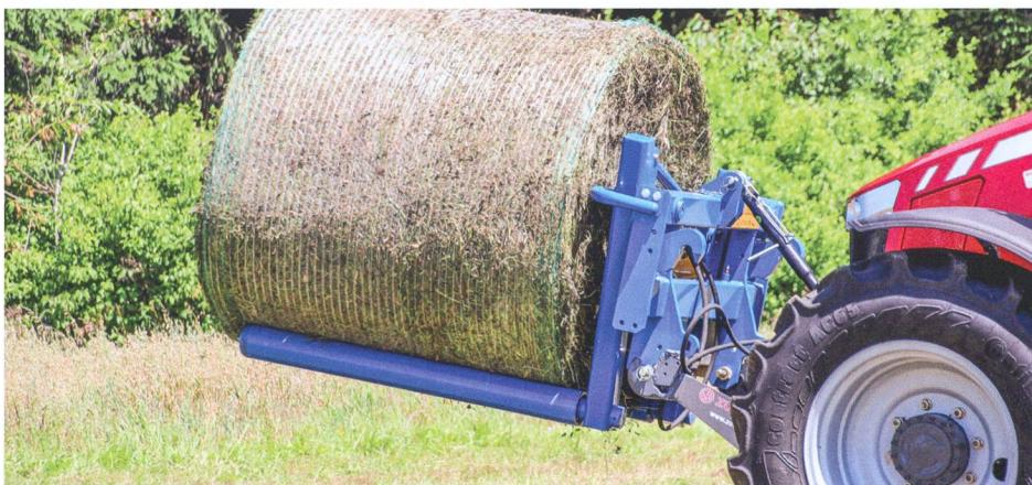
**Pas ainsi sur la route!** Certes, la fourche peut être placée à l'avant du tracteur pendant les voyages à vide sur la voie publique, si elle est correctement signalisée et si le porte-à-faux avant ne dépasse pas 4 m (un miroir en V est nécessaire dès 3 m). Lors des transports routiers en revanche, la fourche doit impérativement être mise à l'arrière et les balles doivent être arrimées avec des sangles, sans que le dispositif d'éclairage soit masqué. Photos: Ruedi Hunger
