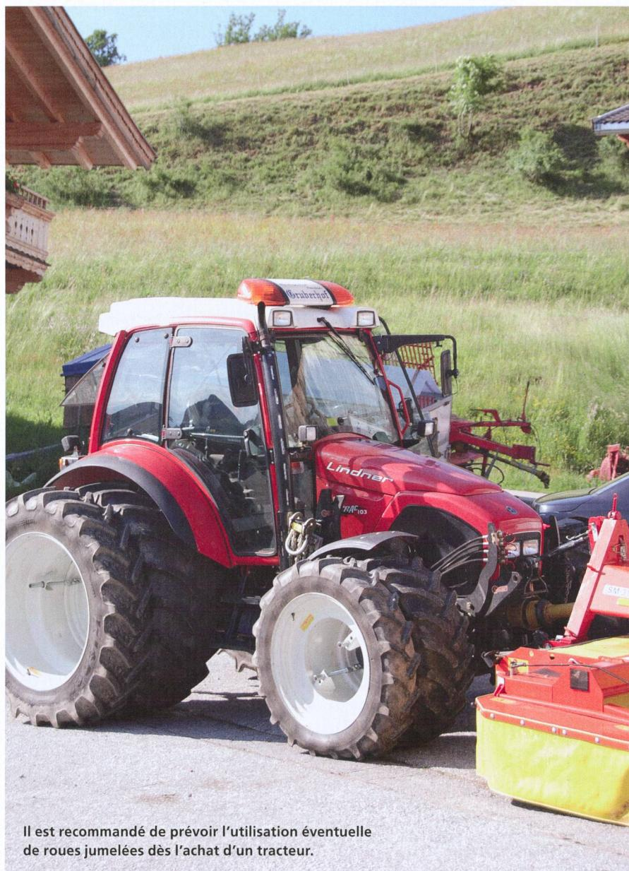
Lors de l'achat d'un tracteur, bon nombre de clients accordent plus d'importance à la taille, au poids et à la performance qu'aux pneumatiques. Souvent, ils se décident pour le montage de pneus larges et espèrent ainsi se passer de roues jumelées.
