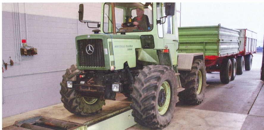
Des exigences minimales légales sont aussi à remplir pour les freins des remorques à 30 km/h. Photos: ASETA-ZH
