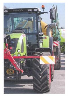
La largeur de la remorque doit être indiquée de manière bien visible sur le véhicule tracteur.
