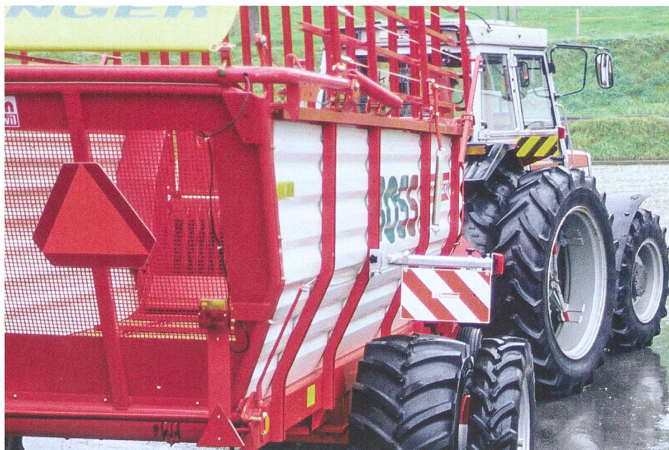
Les remorques agricoles de transport peuvent avoir jusqu'à 3 m de largeur avec des roues jumelées temporaires. La largeur du véhicule doit être signalisée de jour avec des panneaux de marquage. Des feux de gabarit sont nécessaires la nuit ou par mauvaise visibilité. Photo: SPAA
