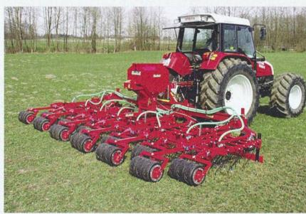
d'attaque. Il suit ainsi de près les irrégularités du terrain, permettant de travailler l'ensemble de la surface de façon régulière. Le volume de la trémie du semoir « Pneumaticbox » est de 300 l, ou de 500 l en option.
