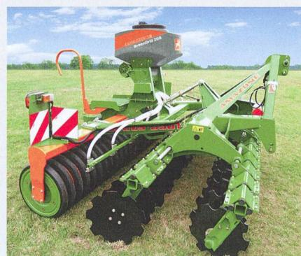
sortie du distributeur, la semence est envoyée par des tuyaux souples vers des diffuseurs qui la mettent en place directement devant ou derrière le rouleau de la machine.
