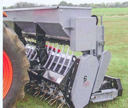
effet de décompaction et d'aération dont l'intensité varie en fonction du régime de la prise de force et de la vitesse de progression de la machine. La semence est déposée devant le rotor et bénéficie, du moins en partie, de l'effet d'enfouissement des vibrations de ce dernier. Elle trouve ensuite dans le sol aéré, décompacté, des conditions idéales à son développement. La surface est finalement légèrement plombée par un rouleau profilé.
