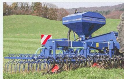
fenêtre permet de suivre le niveau de remplissage. La turbine du semoir est entraînée directement par la prise de force. Le « Grasmaster » peut être doté d'une lame de nivellement (levelboard) à hauteur réglable et d'un stop hydraulique.
