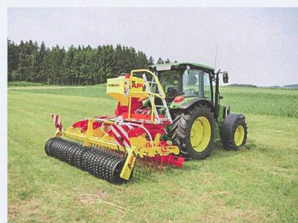
les plus complètes, dites « Full Edition », ces machines peuvent être dotées de nombreux équipements complémentaires: semoir pneumatique, éclairage, échelle d'accès, ventilateur électrique avec module de commande, radar et capteur pour le relevage.
