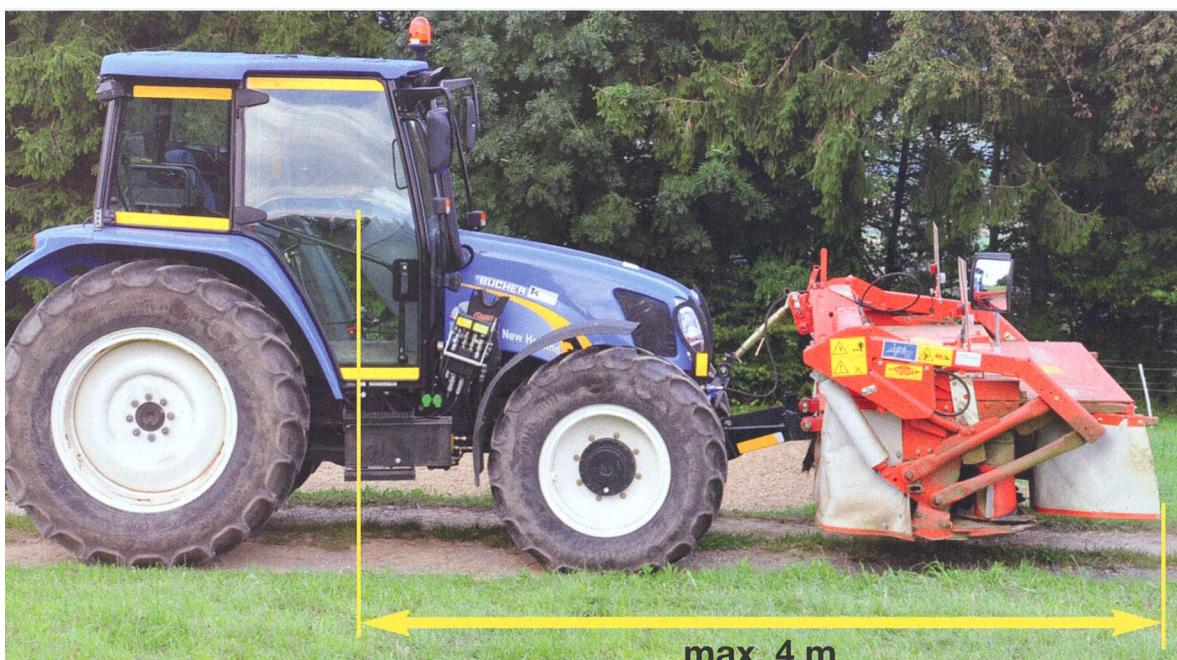
La limite maximale de quatre mètres de porte-à-faux avant n'est pratiquement plus tenable avec des tracteurs et des outils dont les tailles ne cessent de croître. Photo: SPAAG
