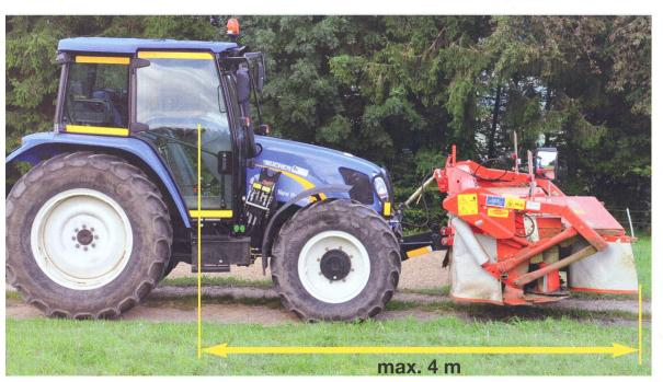
La limite maximale de quatre mètres de porte-à-faux avant n'est pratiquement plus tenable avec des tracteurs et des outils dont les tailles ne cessent de croître. Photo: SPAA
