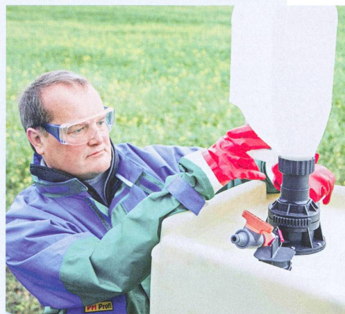
« Chaque goutte compte », système de remplissage de produits phytosanitaires sans giclement. Photo: BCS
