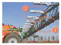
Parmi les nouveautés probantes d'AmaSpot, on notera les capteurs (1) « Green-Sense » montés sur les rampes d'épandage et les nouvelles buses de modulation pulsée (2). Photo: Amazone
