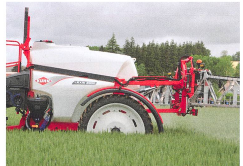
Kuhn a complété sa gamme de pulvérisateurs par le modèle traîné «Lexis 3000». Le pulvérisateur à commande simple est disponible avec des rampes en aluminium de 18 à 24 mètres.
