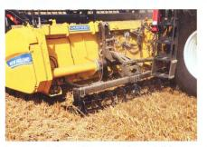
La coupe à deux niveaux est bien visible sur la photographie. Le dispositif de fauchage traditionnel coupe uniquement la partie supérieure des chaumes.
