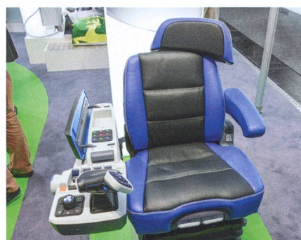
Nouveau siège avec suspension horizontale et de côtés réglée de manière semi-active et soutien de dos modulable.
