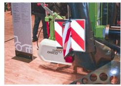
Panneaux de signalisation angulaires, pour être vus de devant, derrière et de côté.
