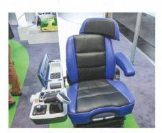
Nouveau siège avec suspension horizontale et de côtés réglée de manière semi-active et soutien de dos modulable.
