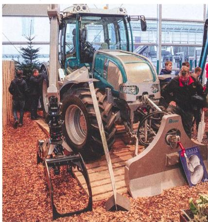
lique à verrouillage automatique qui améliorent sa stabilité. Sa cabine panoramique est équipée d'un poste de pilotage pivotant électriquement sur 340°, pour un travail ergonomique et une visibilité optimale.
