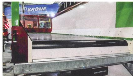
« Schnitzel », ensilages ou céréales peuvent être véhiculés aussi bien que le colza, des pulvérulents, des big bags ou des palettes. Une trentaine de rouleaux de soutien maintiennent le tapis en place et garantissent un déchargement intégral de la remorque. Le rouleau de renvoi arrière, caoutchouté, sert d' entraînement, celui de devant maintient le tapis sous tension.
