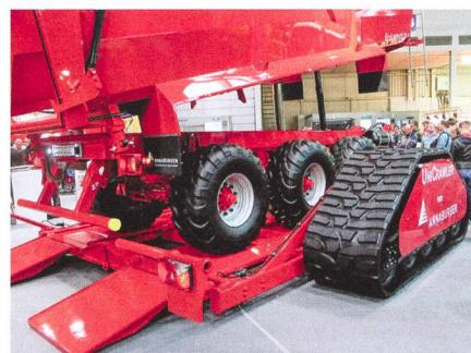
revenir sur la route, il n'a qu'à desserrer le frein de la remorque. La plateforme se replie hydrauliquement à 2,4m pour le transport sur route.
