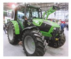
Un concept de tracteur de type « 5120 C » était présenté par Deutz-Fahr qui a développé son moteur à gaz avec le motoriste Deutz, l'Université de Rostock et l'institut Thünen. C'est un moteur diesel classique transformé en moteur Otto pour tourner au gaz naturel. « Il est aussi puissant qu'un diesel tout en émettant moins de polluants et de CO2 », remarquent les ingénieurs. Ce moteur de tracteur devrait tourner à 100 % au gaz naturel et au biométhane.
