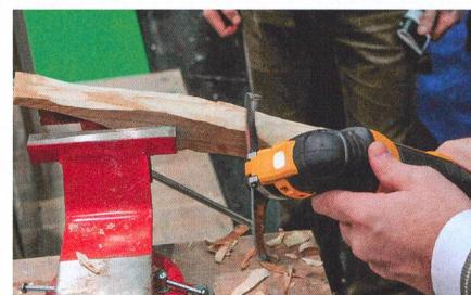
exploitants, comme alternative ou complément à la disqueuse. Le couteau double se fixe à un vibreur multifonctionnel courant du commerce. Avantages principaux: la rainette travaille sans échauffer les ongloins ni dégager de particules, ce qui permet de travailler sans lunettes. En plus, la taille effilée du couteau double et son poids plume doivent permettre d'accéder à des endroits trop exigus pour une meuleuse d'angle.
