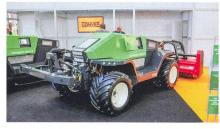
Le « Greenbot » du constructeur néerlandais Conver BV est un engin analogue à un tracteur capable de s'acquitter de manière autonome de différents travaux: fauche, broyage, etc. Il fonctionne en utilisant la cartographie de la parcelle ou de l'espace à traiter. Ce système remplit-il les conditions légales pour effectuer certains travaux dangereux comme le broyage? La question reste ouverte.
