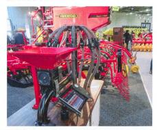
Väderstad présentait le système de comptage des grains développé avec son partenaire hongrois Digitroll. Ce « SeedEye » s'utilise sur les semoirs « Spirit R » et « Rapid A ». Le chauffeur fixe le nombre de graines au mètre carré et la machine s'occupe automatiquement du reste. Rapidité, précision et extension des capacités étaient
