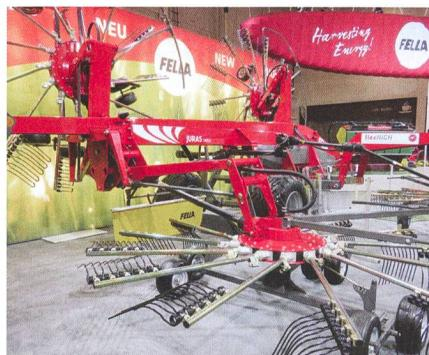
de l'intéressant système de gestion « pro-connect » que Fella intègre sur ses machines à connection Isobus. « pro-connect » réunit trois fonctions : la « flexHigh » gère automatiquement la hauteur des dents, « gapControl » dirige la trajectoire de la machine pour éviter les chevauchements et « Fella myMemory » est le dispositif de contrôle de l'andaineur.
