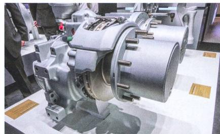
La transmission « TerraPower » était l'un des objets phares présentés, pour des puissances allant de 180 à 210 chevaux. Autre attraction : la « TMG 45 » est conçue pour des tracteurs jusqu'à 450 chevaux. Un moyeu à entraînement électrique individuel à usage agricole a suscité beaucoup d'intérêt sur le stand.
