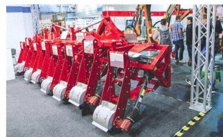
Grâce au guidage parallèle des rotors, le biotope des pyrales est chamboulé sur l'ensemble de la surface, y compris dans les ornières et les terrains accidentés. La consommation de carburant à l'hectare est moins élevée que pour un hersage complet de la surface. L'entraînement des rotors peut être soit mécanique, soit hydraulique.
