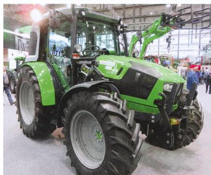
Un concept de tracteur de type « 5120 C » était présenté par Deutz-Fahr qui a développé son moteur à gaz avec le motoriste Deutz, l'Université de Rostock et l'institut Thünen. C'est un moteur diesel classique transformé en moteur Otto pour tourner au gaz naturel. « Il est aussi puissant qu'un diesel tout en émettant moins de polluants et de CO<sub>2</sub> », remarquent les ingénieurs. Ce moteur de tracteur devrait tourner à 100 % au gaz naturel et au biométhane.
