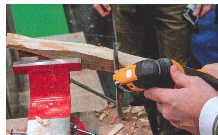
exploitants, comme alternative ou complément à la disqueuse. Le couteau double se fixe à un vibreur multifonctionnel courant du commerce. Avantages principaux: la rainette travaille sans échauffer les ongloins ni dégager de particules, ce qui permet de travailler sans lunettes. En plus, la taille effilée du couteau double et son poids plume doivent permettre d'accéder à des endroits trop exigus pour une meuleuse d'angle.
