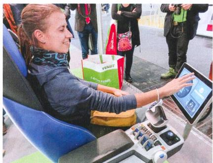
fonction à écran tactile Grammer, un instrument déjà connu permettant d'ajuster et mémoriser l'assise pour chaque utilisateur. Il intègre des fonctions inédites, comme un système de massage, un chauffage et une suspension à réglage électro-nique horizontal et vertical.
