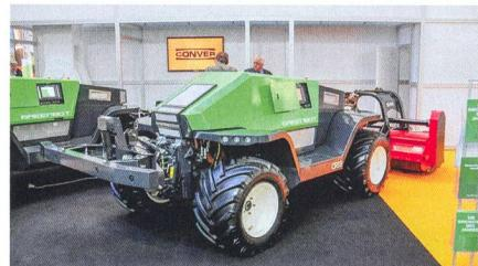
Le « Greenbot » du constructeur néerlandais Conver BV est un engin analogue à un tracteur capable de s'acquitter de manière autonome de différents travaux : fauche, broyage, etc. Il fonctionne en utilisant la cartographie de la parcelle ou de l'espace à traiter. Ce système remplit-il les conditions légales pour effectuer certains travaux dangereux comme le broyage ? La question reste ouverte.
