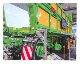
dynamique pour ses remorques de transport et d'épandage! Il fonctionne avec deux capteurs sur le train roulant, un autre sur le timon suspendu et transmet par liaison sans fil le poids du véhicule au conducteur du tracteur ou du chargeur. Joskin exposait aussi un essieu moteur électrique pour remorque « E-Drive ».
