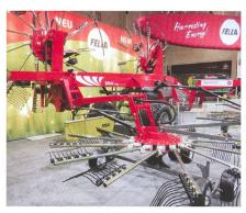
de l'intéressant système de gestion « proconnect » que Fella intègre sur ses machines à connection Isobus. « pro-connect » réunit trois fonctions: la « flexHigh » gère automatiquement la hauteur des dents, « gapControl » dirige la trajectoire de la machine pour éviter les chevauchements et « Fella myMemory » est le dispositif de contrôle de l'andaineur.
