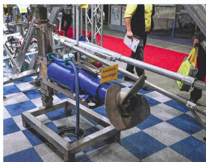
Le nouveau brasseur immersible « Orka » brasse dans les deux sens.
