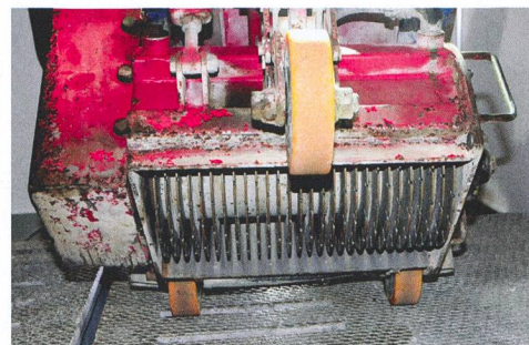
Le procédé de fraisage de rainures (Lorenz Agner, Buttisholz LU) permet d'améliorer durablement la résistance au dérapage.
