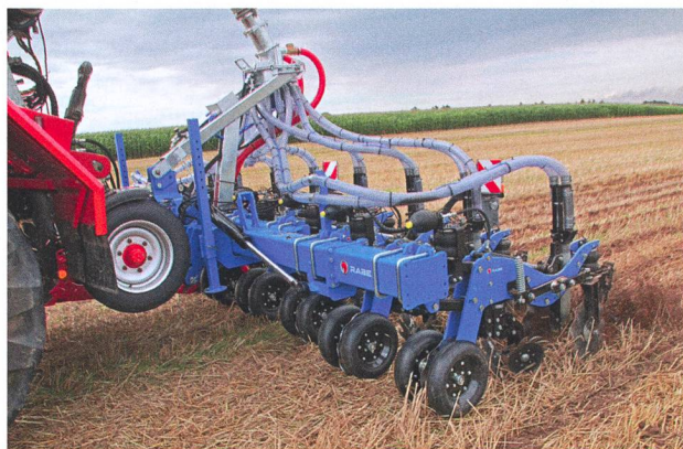
Le travail du sol en bandes combine les avantages du travail conventionnel du sol et ceux de la pratique aratoire conservatrice. Photo: Idd
