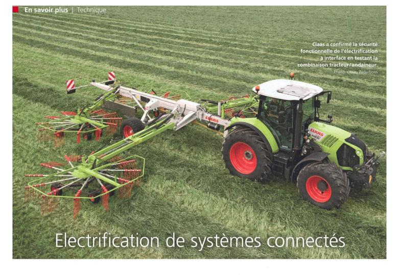
Le développement des transmissions électriques et de leur connexion dans des systèmes tout électriques semble prometteur pour améliorer les performances des machines agricoles. Pour vérifier cette approche encore théorique jusqu'à présent, Claas a testé une combinaison électrifiée tracteur et outil atelé.
