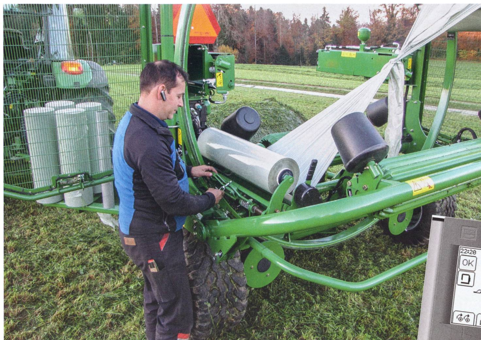
Le changement des rouleaux de film s'effectue à une hauteur optimale et dans de bonnes conditions d'accessibilité. Photos: Ruedi Burkhalter
