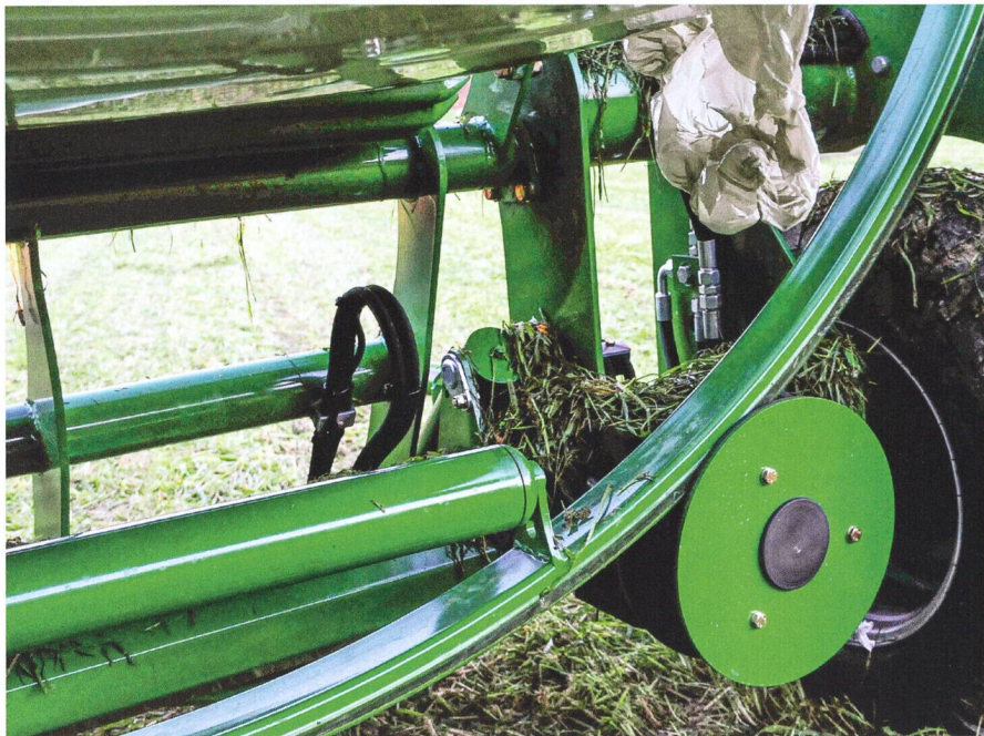
Deux rouleaux enrobés de caoutchouc en partie basse, entraînés par l'hydraulique du tracteur, assurent la rotation de l'anneau d'enrubannage.
