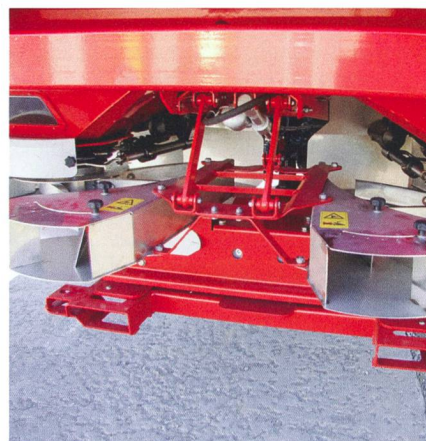
Grâce au dispositif d'épandage en bordure, lors du premier trajet de roulage du champ, il est possible de suivre exactement les limites extérieures du champ.
