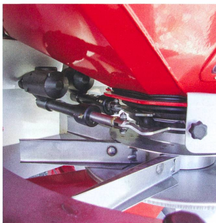
Un moteur de positionnement (noir) règle le débit, un second moteur ajuste le point de chute de l'engrais.
