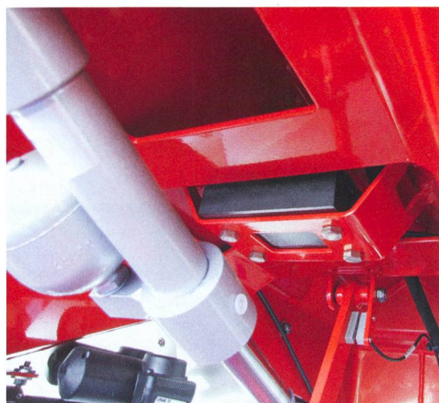
Placés sous le réservoir, ces capteurs détectent la déclivité du terrain et les accélérations provoquées par un sol inégal (correction de pesage).
