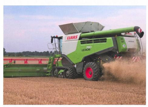
Dans sa nouvelle gamme «Lexion», Claas met en œuvre un système automatique destiné à prévenir les bourrages.
