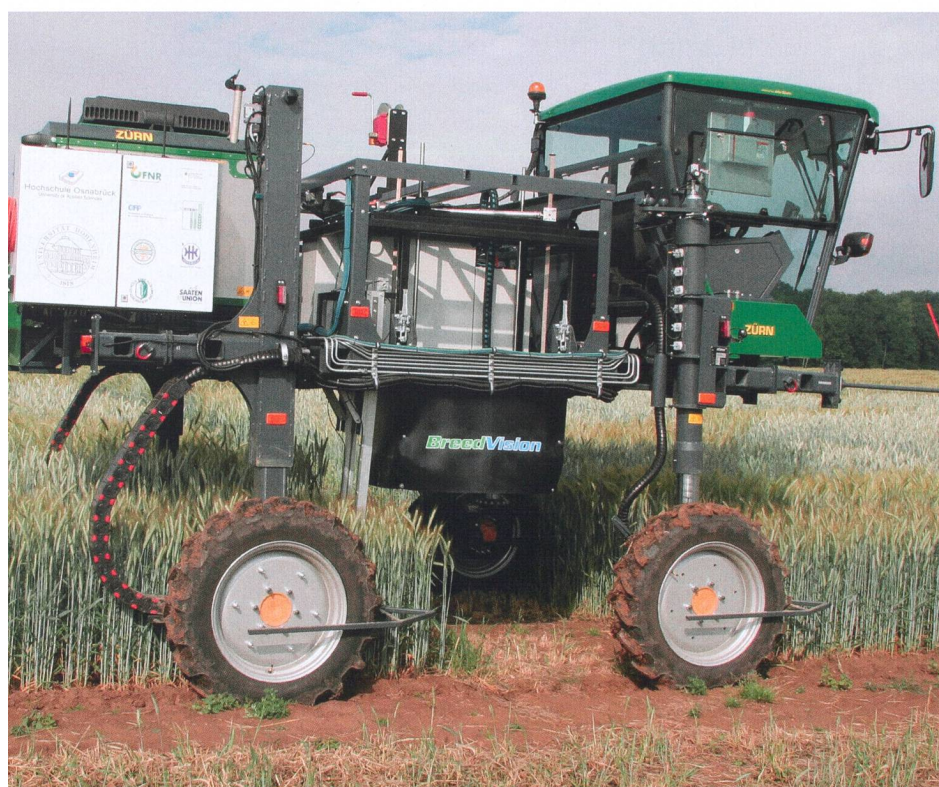
Projet de recherche «PredBreed» : plateforme mobile de phénotypisation destinée à mesurer des caractéristiques des plantes dans la sélection de nouvelles variétés d'ensemencement céréalières.
