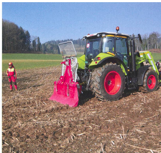
Le treuil est essentiel pour un travail en toute sécurité, mais il doit être conforme aux exigences de sécurité. Le tracteur devrait avoir environ douze chevaux par tonne de force de traction du treuil. Son poids est également déterminant.
