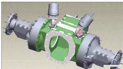
Des accumulateurs à ressorts externes équipent les freins de service du Fendt «Vario 900».
