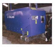
Dans le cas des procédés à chariot sur rails, le fourrage est distribué par un chariot qui circule le long de la table d'affouragement. Le chariot est suspendu entièrement ou partiellement à un rail, qui assure en même temps son alimentation électrique. Il existe des procédés à mélangeuse fixe où le chariot n'effectue que la distribution, et des procédés où le chariot à entraînement électrique assure à la fois les fonctions de mélangeur et de distributeur.
