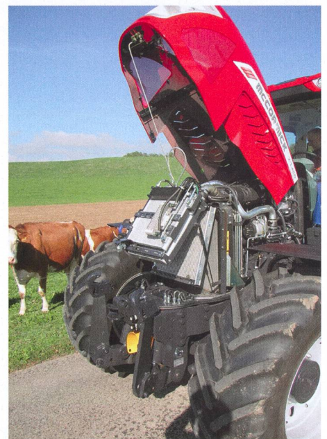
Il suffit de déplier le système de refroidissement du moteur FPT pour le nettoyer.
