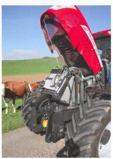
Il suffit de déplier le système de refroidissement du moteur FPT pour le nettoyer.
