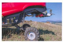
Les deux vérins hydrauliques permettent de compenser jusqu'à 30 % de devers dans l'axe longitudinal.
