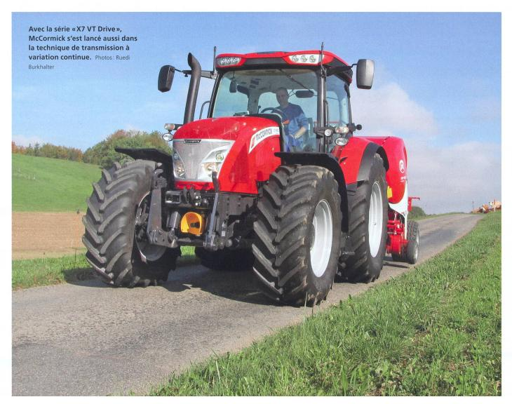
Le changement de marche avant et arrière s'effectue comme pour les modèles à embrayage avec un inverseur Powershuttle après la transmission CVT avec deux paquets de lamelles. La particularité, c'est l'unité hydrostatique fixée latéralement qui permet une bonne accessibilité pour les travaux de maintenance et de réparation. Les transmissions « Terramatic » ont hérité ces caractéristiques des unités « S-Matic ».
