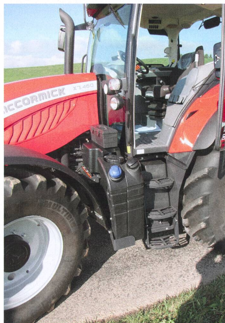
Les réservoirs diesel et AdBlue sont disposés à côté de l'accès (large) à la cabine.
