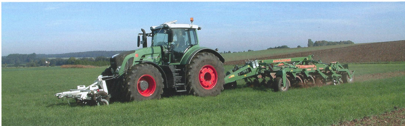
Nouvelles possibilités: ce cultivateur est guidé en temps réel par des capteurs frontaux déterminant la profondeur à ameublir en fonction de la texture du sol.
