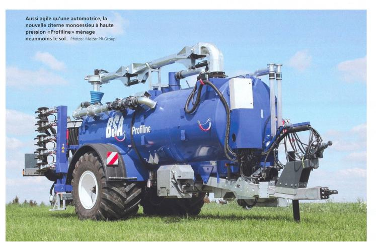
De par sa conception, tous les outils d'enfouissement et d'épandage courants peuvent être montés. Une variante à deux compartiments est également disponible pour faciliter le maintien d'une charge d'appui suffisante.
