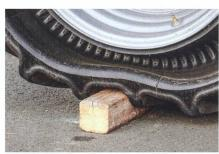
Le «PneuTrac» se distingue par des surfaces de contact plus importantes et des zones de compression plus étendues lors du passage d'obstacles.
