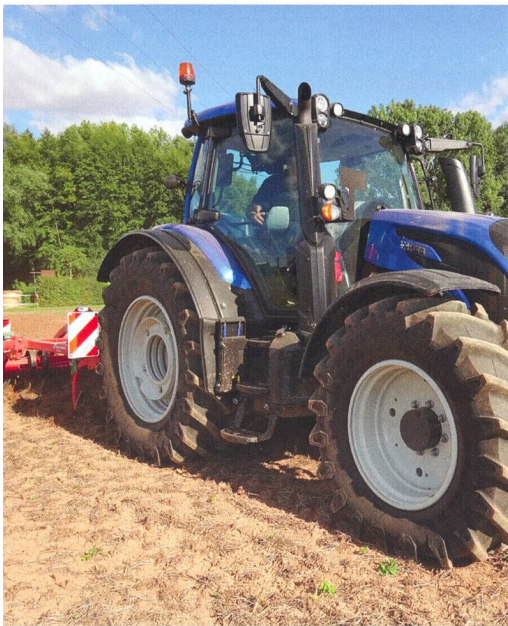
La régulation antipatinage mise en œuvre par Valtra dans sa dernière série «N4» revêt une importance surtout pour le travail du sol. Photos: Roman Engeler
