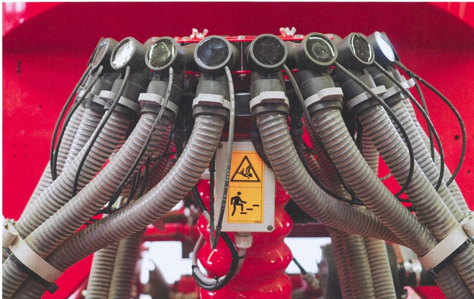
Ne nécessitant aucun calibrage, le « SeedControl » permet de calculer le nombre de semences et la densité de semis en grains par mètre carré.
