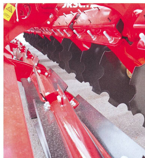
Le déchaumeur «Joker» est maintenant doté d'un tambour de coupe qui assure un bon hachage des cannes de colza ou de tournesol.
