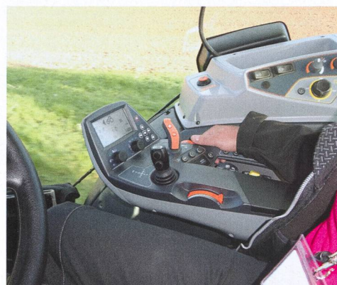
Sur les modèles «Versu» et «Direct», les commandes des distributeurs électriques sont regroupées sur l'accoudoir.
