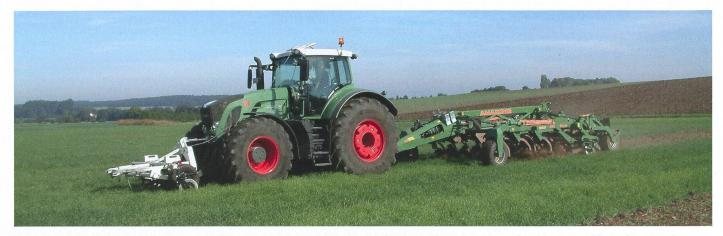
Nouvelles possibilités: ce cultivateur est guidé en temps réel par des capteurs frontaux déterminant la profondeur à ameublir en fonction de la texture du sol.
