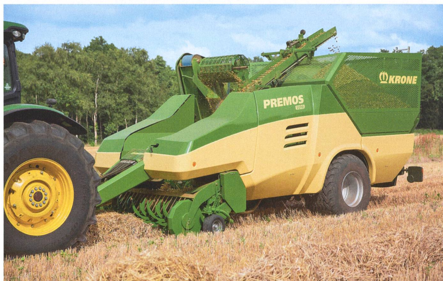
La «Premos 5000» de Krone est une invention totalement inédite, toute en fer et en acier, qui produit des granulés directement dans les champs. Photo : Krone
