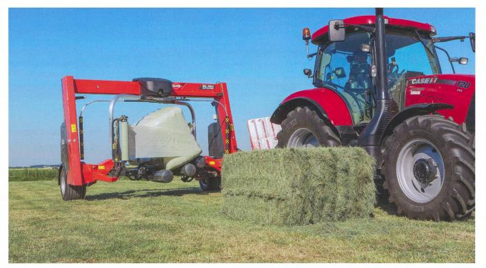
Avec la fonction «Auto Load» de son enrubanneuse «SW 1414», Kuhn garantit une mise sous film non-stop des balles rondes et parallélipipédiques, sans aucune intervention du conducteur. Photo: Kuhn
