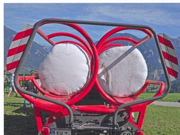
Grâce à la direction à quatre roues, le transporteur est très mobile lors du ramassage des balles. En raison du centre de gravité élevé, il ne peut que circuler sur la route, et sa largeur dépasse aussi la largeur permise de 255 cm.
