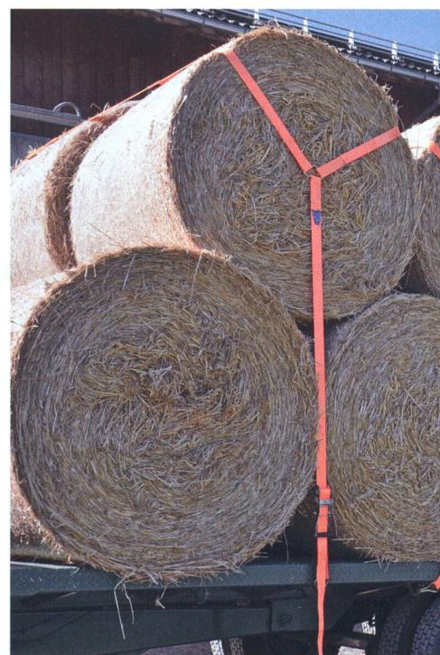
pour un transporteur, le centre de gravité élevé diminue fortement la capacité de déplacement en pente. De surcroît, la largeur de cet appareil dépasse aussi les 255 cm tolérés par la Loi sur la circulation routière (LCR).
