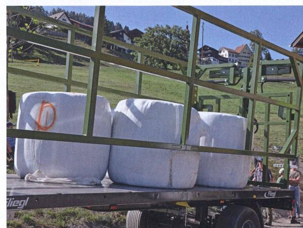
Le chariot à balles Fiegl verrouille le haillon latéral hydrauliquement et sécurise ainsi les balles rondes. Si le chariot a été chargé correctement, aucun autre mode de sécurisation supplémentaire n'est nécessaire.
