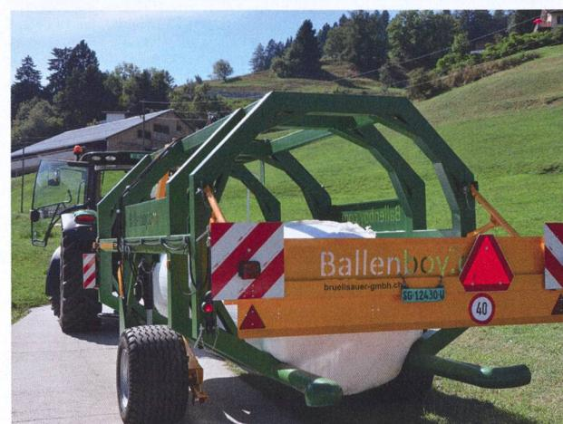
Le Ballenboy autrichien ramasse les balles latéralement par l'avant. Il est équipé d'un timon orientable/pliant. Sa dimension hors tout avec pneus de 270 cm (châssis 255 cm) nécessite une plaque d'immatriculation brune.
