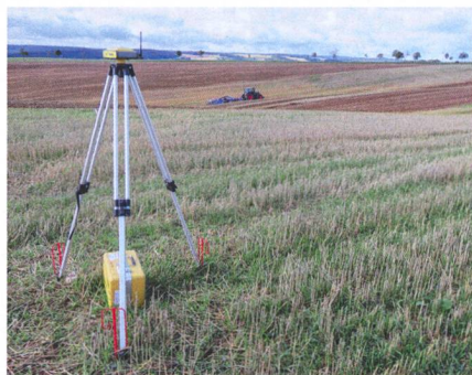
Le système de positionnement GPS avec antenne RTK supplémentaire est indispensable pour de nombreuses utilisations de haute précision.
