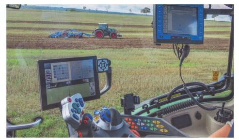
Commande moderne des machines agricoles: le contrôle complet des machines attelées peut se faire via le terminal Isobus Fendt. Afin de supporter les fonctions d'affichage et de commande, un terminal CCI supplémentaire est installé dans cette cabine.
