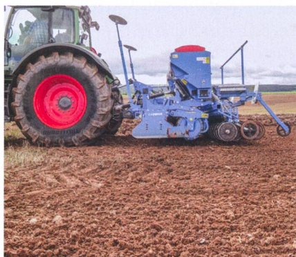
En bout de champ, le déclenchement du dosage et du levage du semoir doit se faire avec un certain ralentissement.
