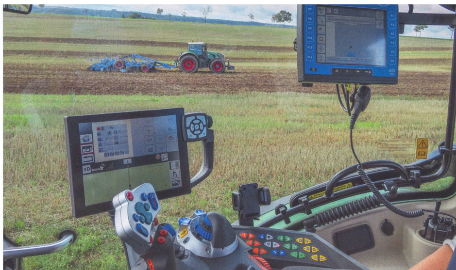
Commande moderne des machines agricoles : le contrôle complet des machines attelées peut se faire via le terminal Isobus Fendt. Afin de supporter les fonctions d'affichage et de commande, un terminal CCI supplémentaire est installé dans cette cabine.
