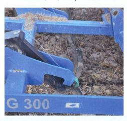
Selon les indications du constructeur, le cultivateur pèse 2900 kg (sans semoir). Après l'essai sur le terrain, nous sommes convaincus que la clé du succès de ce cultivateur réside dans sa précision de travail. Il existe aussi des possibilités de réglages supplémentaires pour une conduite en profondeur exacte. En effet, pour effectuer un travail à plat et de précision, il faut prendre quelques minutes pour un réglage adéquat. Nous sommes toutefois d'avis que c'est du temps bien investi.
