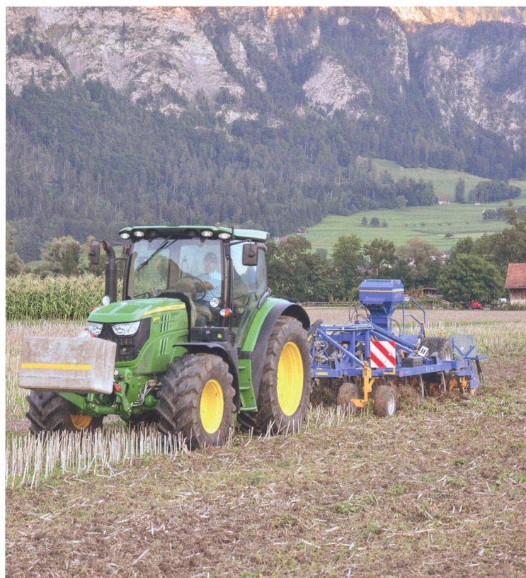
Le cultivateur de précision de l'entreprise Treffler est prédestiné pour le travail du sol à plat avec une coupe sur une grande surface de mauvaises herbes.
