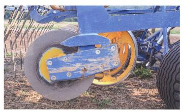
Le cultivateur est soutenu à l'arrière par deux rouleaux packers pendulaires combinés. Sur demande, une roue à disque peut être montée pour la stabilisation du cultivateur en pente.
