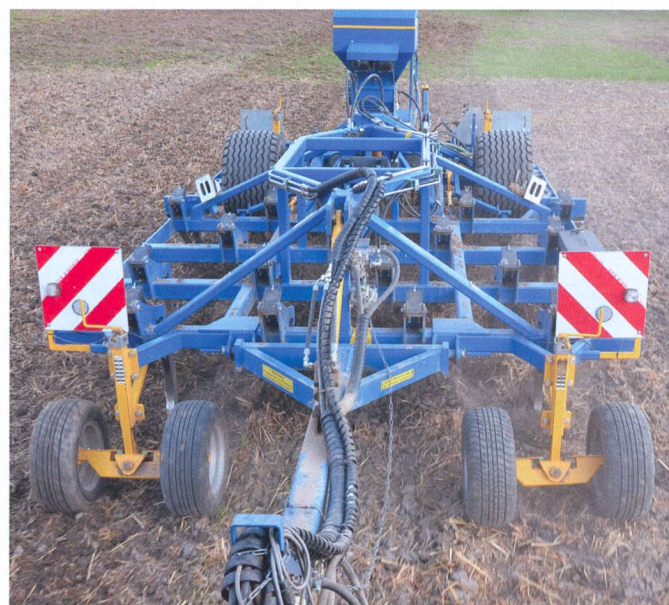
Le cultivateur de précision de l'entreprise Treffler est prédestiné pour le travail du sol à plat avec une coupe sur une grande surface de mauvaises herbes.
