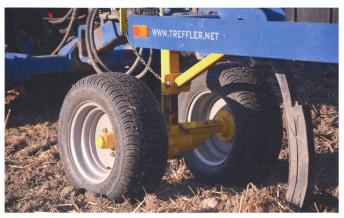
Treffler a trouvé une solution en utilisant une paire de roues de jauges pivotantes pour une profondeur fiable de travail alliée avec une bonne adaptation au sol.
