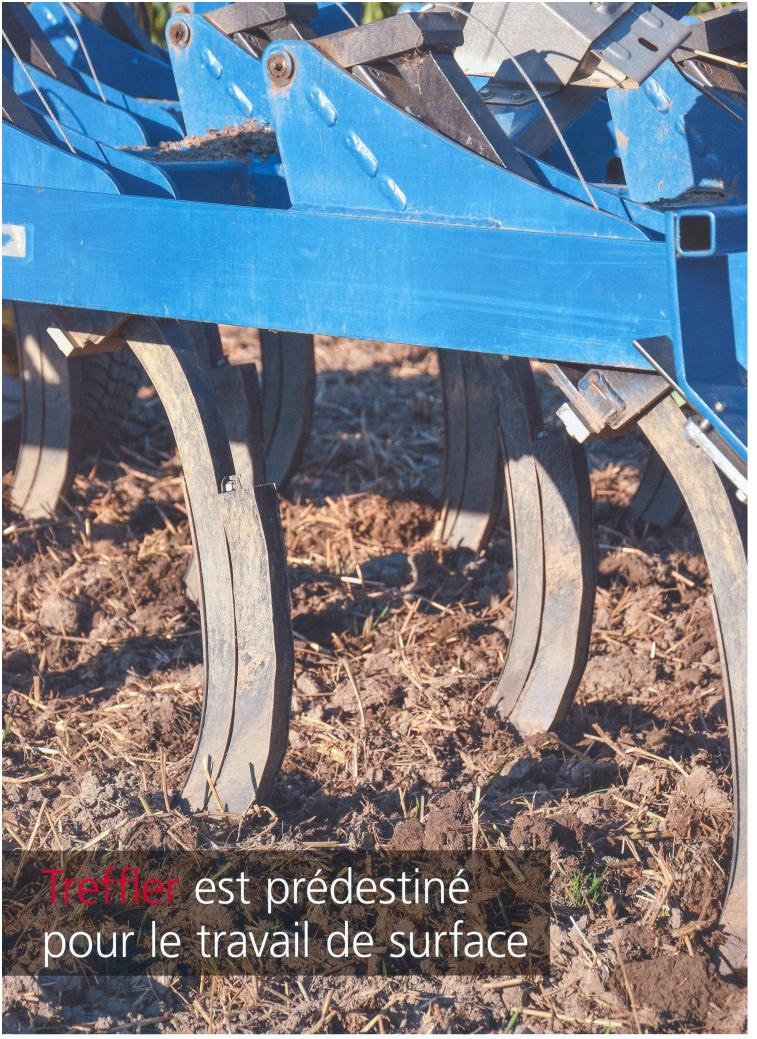
Les socs de 26 cm de large en forme de patte-d'oie sont disposés à plat sur toute la largeur de travail et ils coupent proprement grâce à un chevauchement parfait. Photos: Ruedi Hunger
