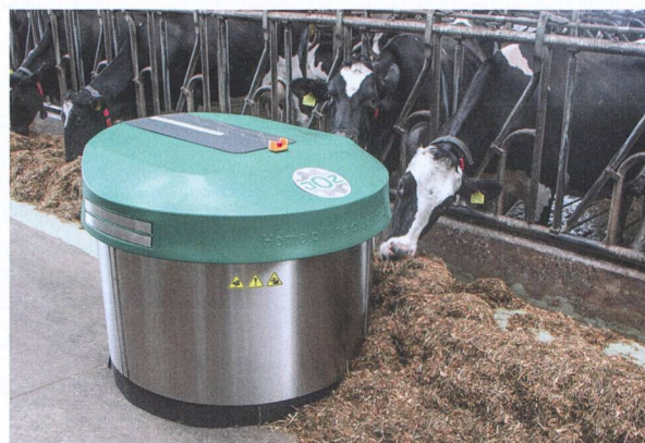
Le pousse-fourrage du constructeur JOZ (Pays-Bas) repousse le fourrage de manière totalement automatique. Communiquant avec un transpondeur en verre ou un gyroscope, il détecte à tout moment sa position dans l'étable.
