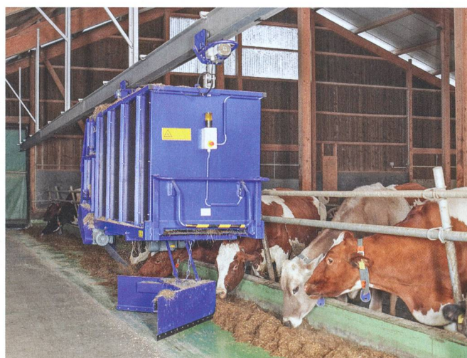
La pièce maîtresse du «Optimat» de DeLaval est un mélangeur fixe. Le chariot de distribution peut également être installé ultérieurement.
