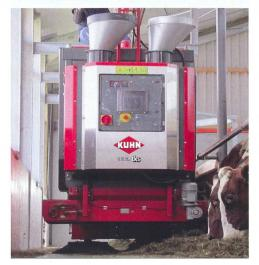
Grâce à un remplissage par couches, le «Feed Robot» de Kuhn mélange les divers composants lors de la distribution.
