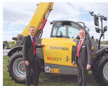
Le directeur général Karl Friedlich Hauri et le directeur de Kramer GmbH, Martin Eppinger, posent pour les 90 ans de l'entreprise devant le chargeur télescopique « 5007 ». Cet engin développe 90 kW, sa hauteur de chargement atteint 7 m pour 4,8 t de charge utile.
