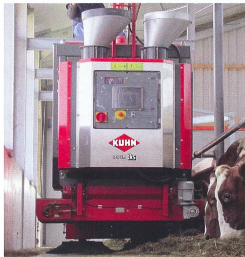
Grâce à un remplissage par couches, le «Feed Robot» de Kuhn mélange les divers composants lors de la distribution.
