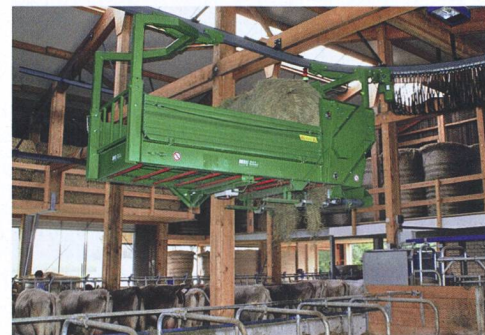
Le système de Sumag peut distribuer le fourrage et épandre la litière automatiquement.
