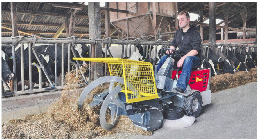
Westermann fabrique non seulement des balayeuses radiales, mais aussi une unité de préparation du fourrage équipée de vis sans fin ouvertes et d'une bande en caoutchouc souple à monter sur un véhicule porteur afin de nettoyer la table d'alimentation.
