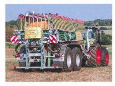
La 10000e citerne de lisier est dotée de la technique la plus récente: le pendillard est fixé par brides au châssis, alors que la structure en trois parties, serrée contre la citerne en position basse, est équipée des patins «GlideFix».
