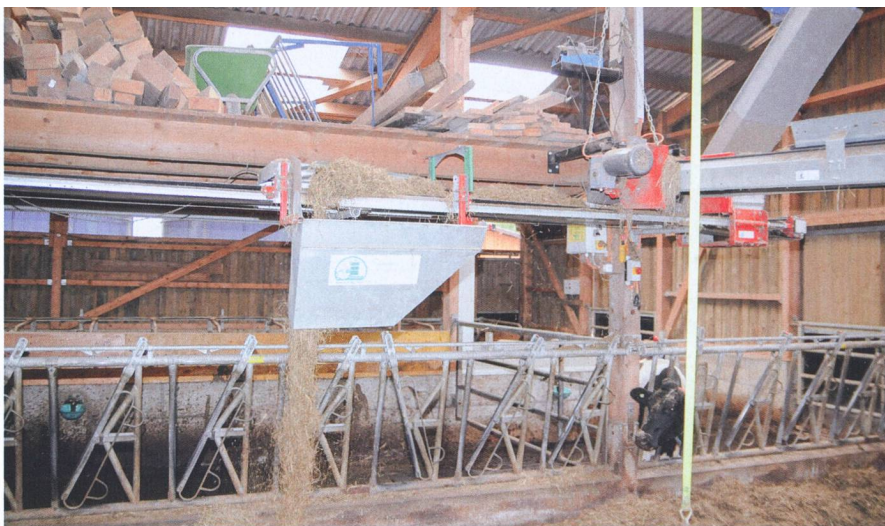
Le convoyeur de distribution est surtout intéressant pour les étables qui se basent à une axe d'affouragement.
