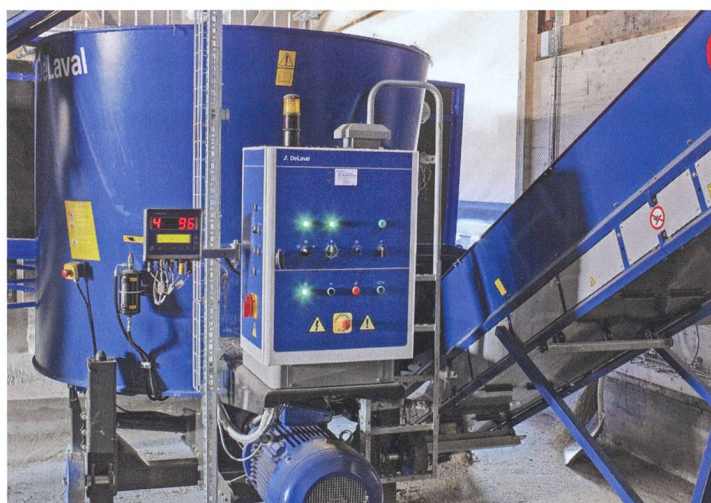
La pièce maîtresse du «Optimat» de DeLaval est un mélangeur fixe. Le chariot de distribution peut également être installé ultérieurement.
